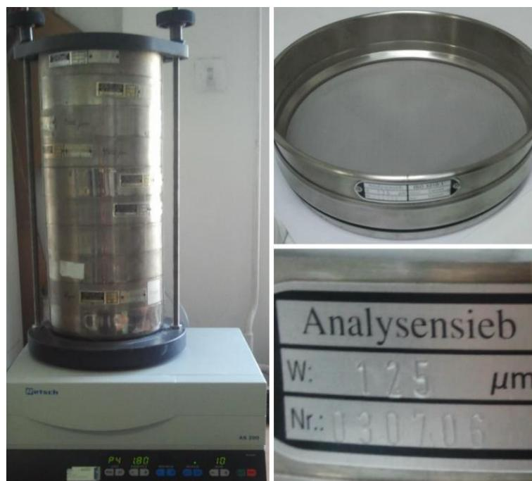
**Slika 39.** Aparatura za provedbu granulometrijske analize prosijavanjem.
