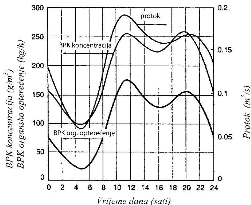
**Slika 1.** Prikaz tipičnih satnih varijacija protoka i onečišćenja komunalne otpadne vode, gdje je BPK izražena kao koncentracija ( $\text{g}/\text{m}^3$ ) i kao organsko opterećenje ( $\text{kg}/\text{h}$ )
