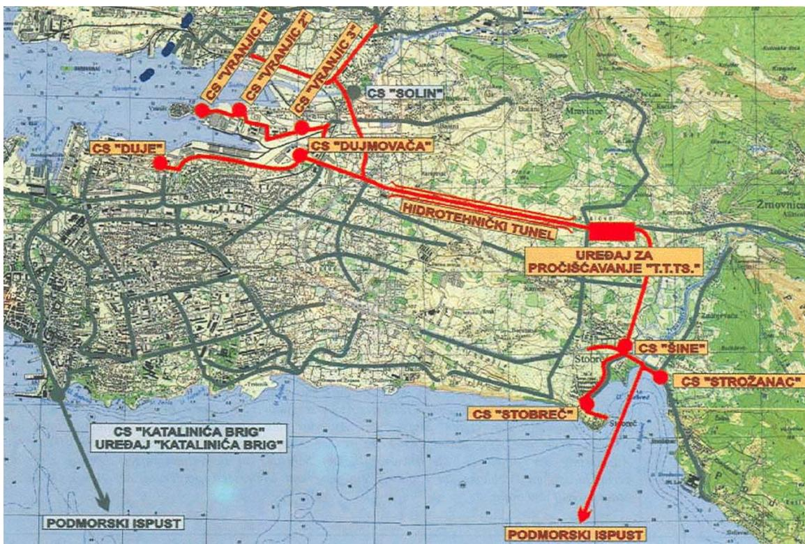
**Slika 8.** Generalni koncept rješenja izgradnje kanalizacijskog sustava Split/Solin
