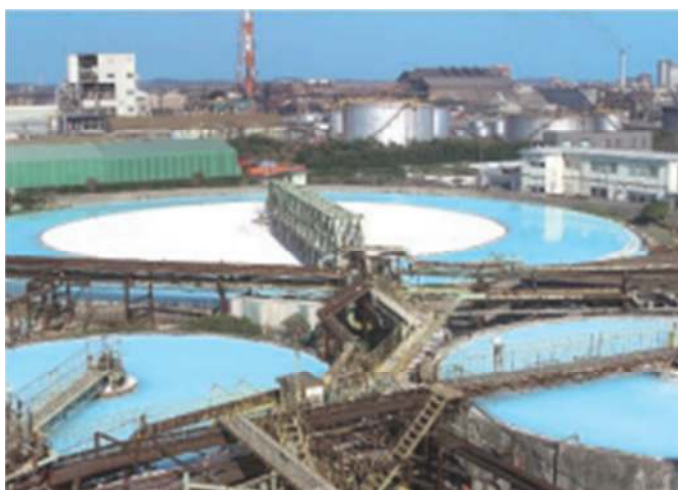
Slika 2.7. Reaktor za taloženje (Ube Plant, Ube Material Industries, Ltd., Japan). 23
