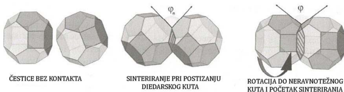
Slika 2.11. Shematski prikaz početka sinteriranja nesfernih čestica. 39
