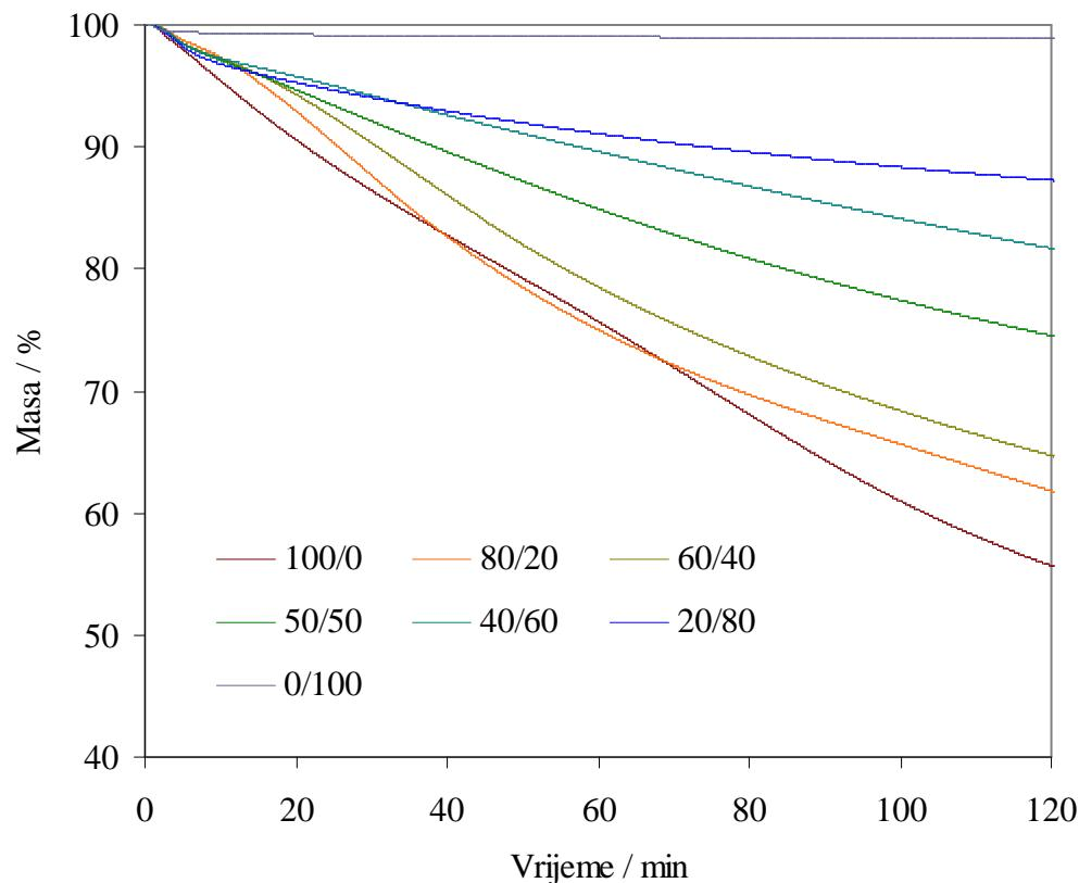
Slika 39. TG krivulje izotermne TG razgradnje mješavina PVC/PEO1 u inertu pri  $240\text{ }^{\circ}\text{C}$
