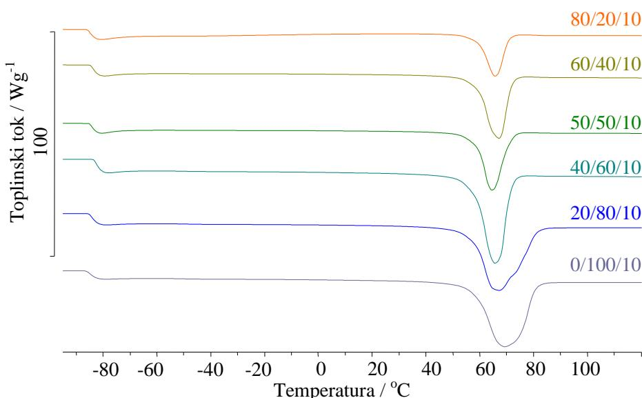
Slika 22. Normalizirane DSC krivulje zagrijavanja mješavina PVC/PEO1/PEG u inertu
