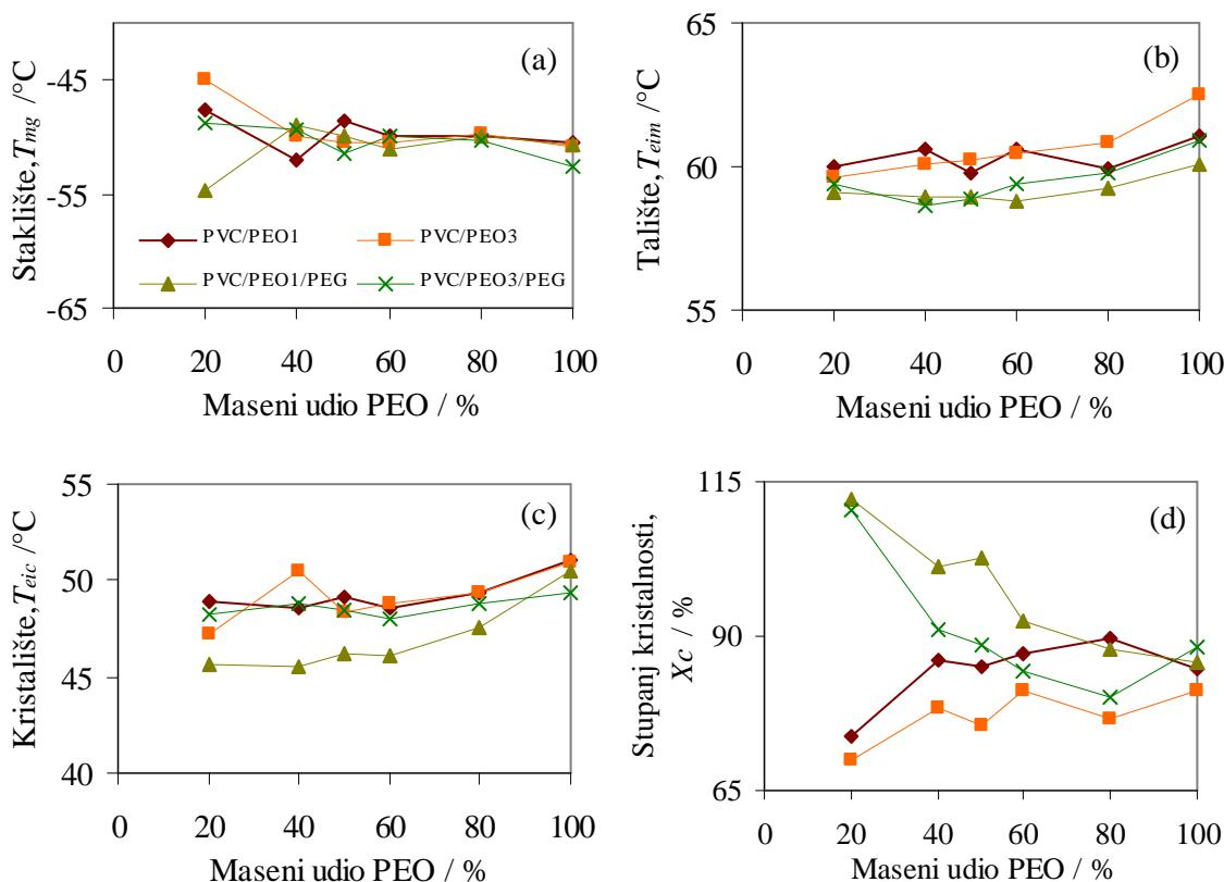
Slika 99. Usporedba temperaturnih značajki DSC krivulja istraživanih mješavina u inertu (a) staklišta, (b) tališta, (c) kristališta i (d) stupnja kristalnosti
