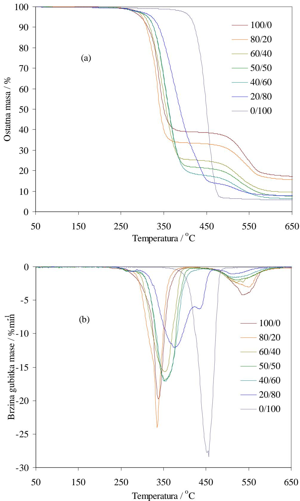
Slika 49. TG (a) i DTG (b) krivulje dinamičke TG razgradnje mješavina PVC/PEO1 različitog sastava u inertu pri brzini zagrijavanja  $10 \text{ }^{\circ}\text{Cmin}^{-1}$
