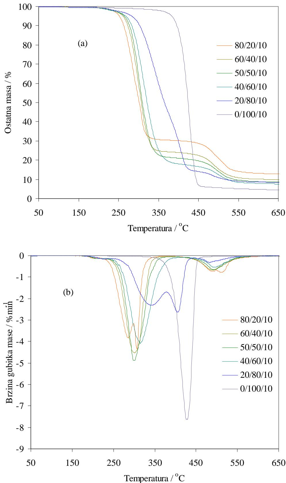
Slika 55. TG (a) i DTG (b) krivulje dinamičke TG razgradnje mješavina PVC/PEO1/PEG različitog sastava u inertu pri brzini zagrijavanja  $2,5 \text{ } ^\circ\text{Cmin}^{-1}$
