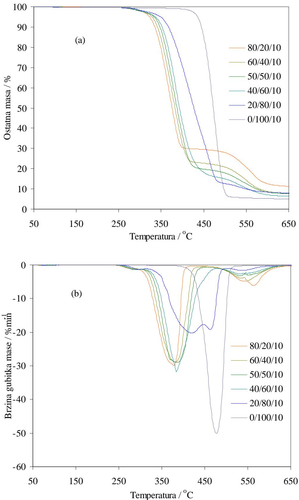
Slika 62. TG (a) i DTG (b) krivulje dinamičke TG razgradnje mješavina PVC/PEO<sub>3</sub>/PEG različitog sastava u inertu pri brzini zagrijavanja  $20 \text{ }^{\circ}\text{Cmin}^{-1}$
