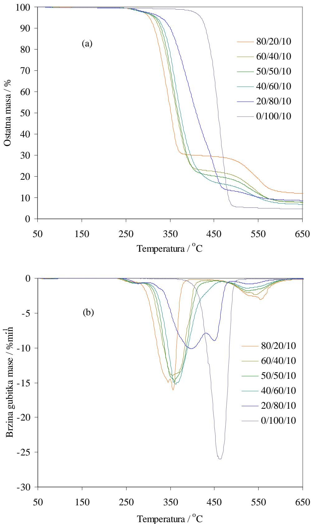
Slika 61. TG (a) i DTG (b) krivulje dinamičke TG razgradnje mješavina PVC/PEO<sub>3</sub>/PEG različitog sastava u inertu pri brzini zagrijavanja  $10\text{ }^{\circ}\text{Cmin}^{-1}$
