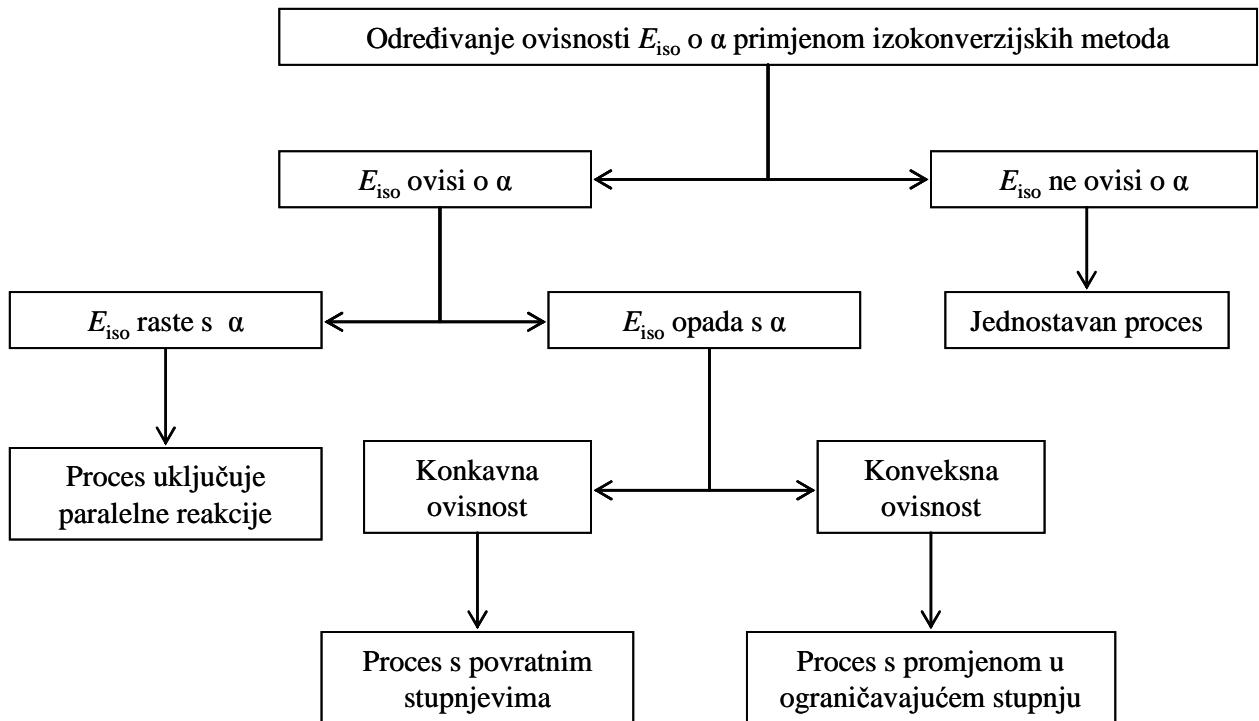
Slika 4. Opći algoritam za identifikaciju kinetičke sheme ispitivanog procesa<sup>65</sup>
