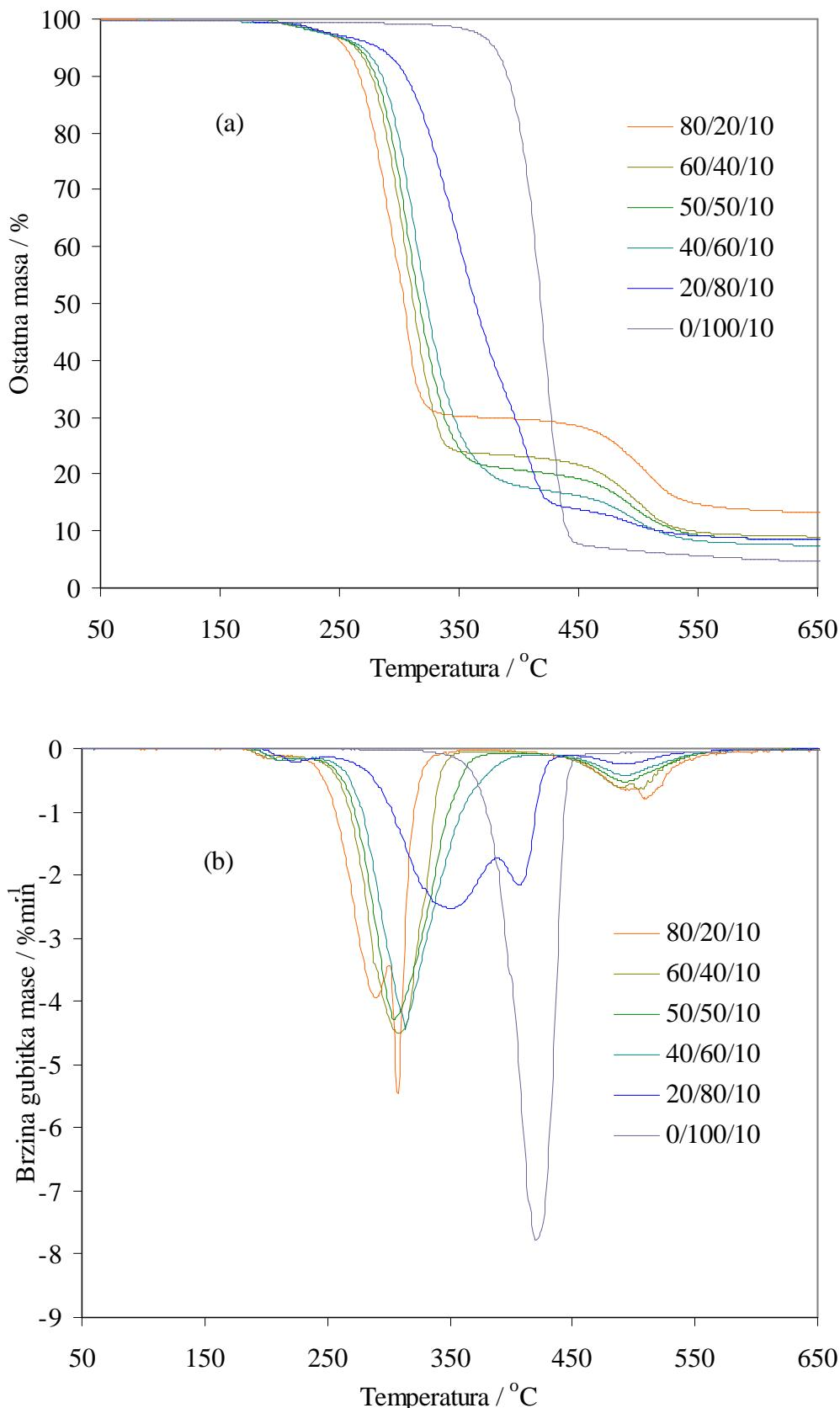
Slika 59. TG (a) i DTG (b) krivulje dinamičke TG razgradnje mješavina PVC/PEO<sub>3</sub>/PEG različitog sastava u inertu pri brzini zagrijavanja  $2,5 \text{ } ^{\circ}\text{Cmin}^{-1}$
