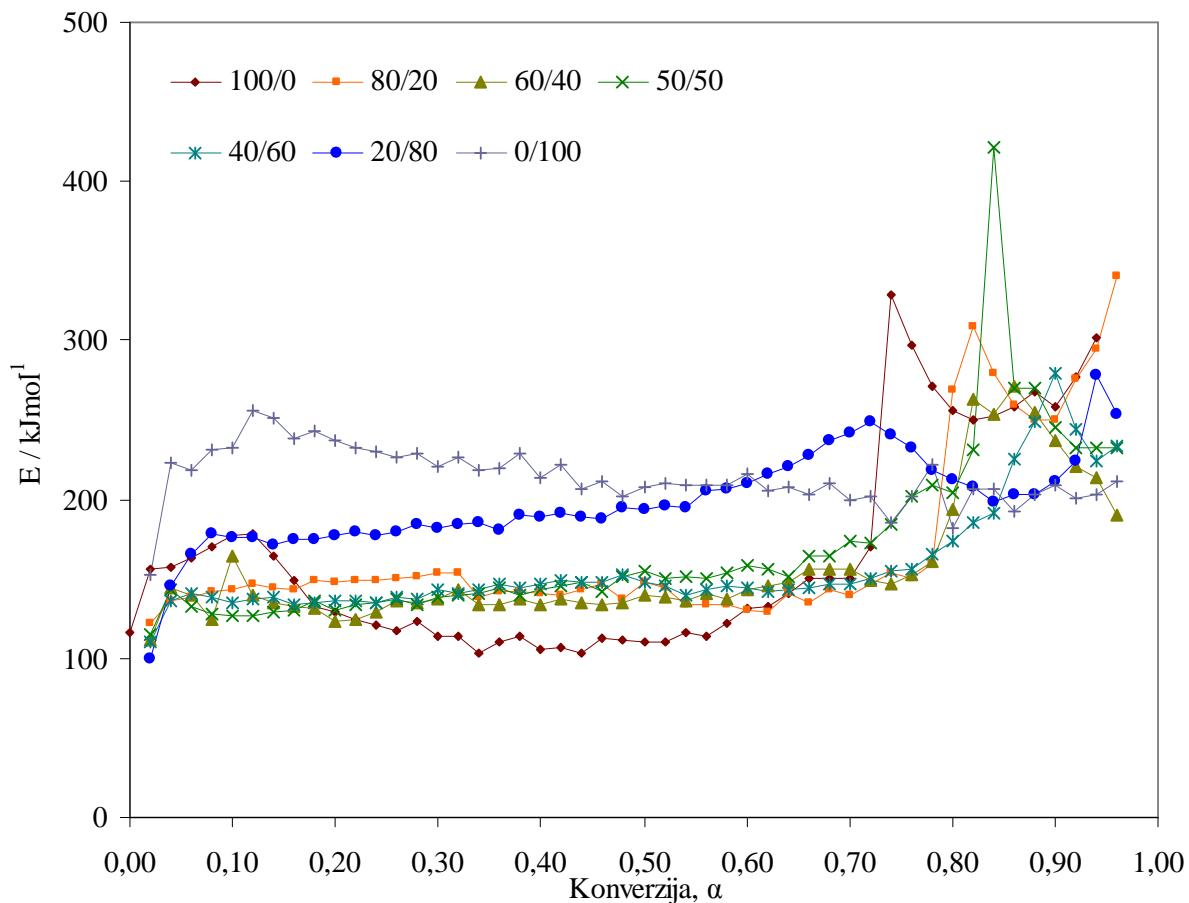
Slika 84. Ovisnost energije aktivacije procesa dinamičke toplinske razgradnje mješavina PVC/PEO1 u inertu o konverziji, izračunata FR metodom
