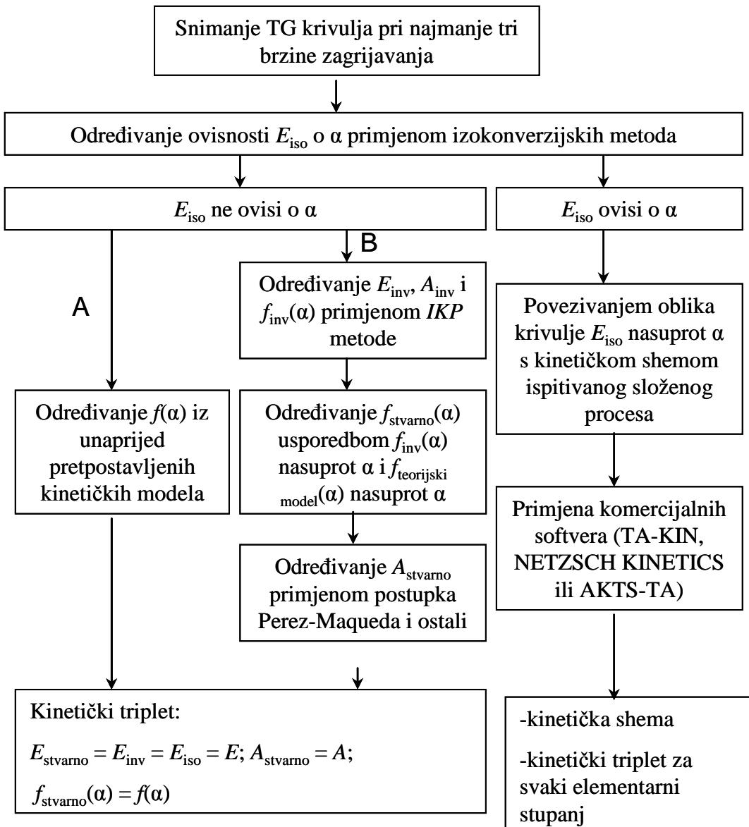
Slika 3. Opći algoritam za određivanje kinetičkih parametara iz dinamičkih TG podataka.<sup>62</sup>
