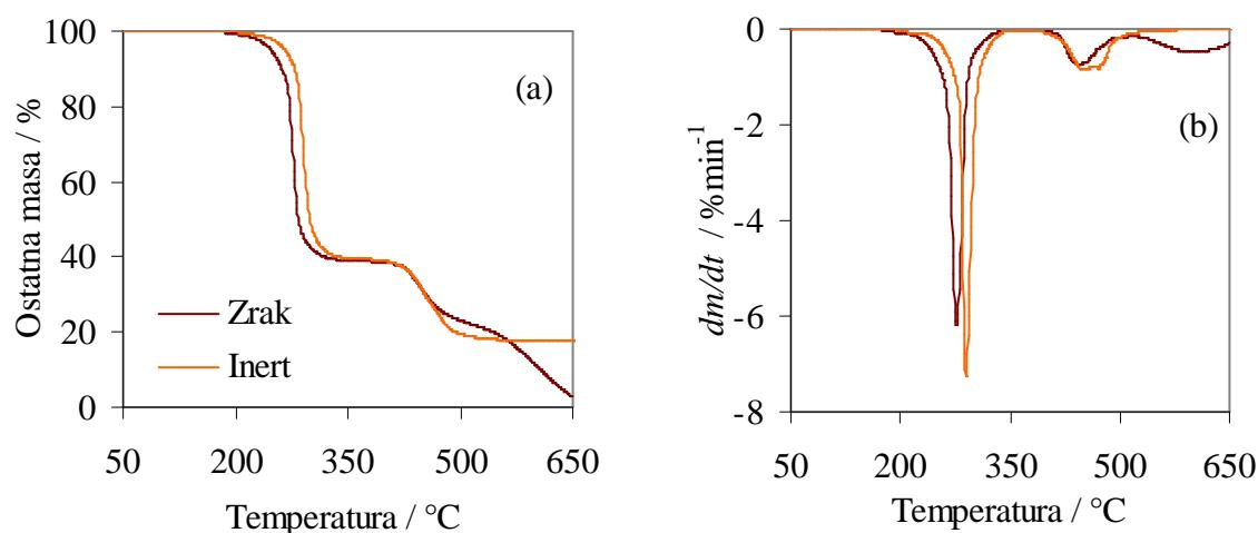
Slika 108. Usporedba krivulja dinamičke TG razgradnje u inertu i zraku, (a) TG i (b) DTG, čistog PVC-a pri brzini zagrijavanja 2,5 °Cmin<sup>-1</sup>
