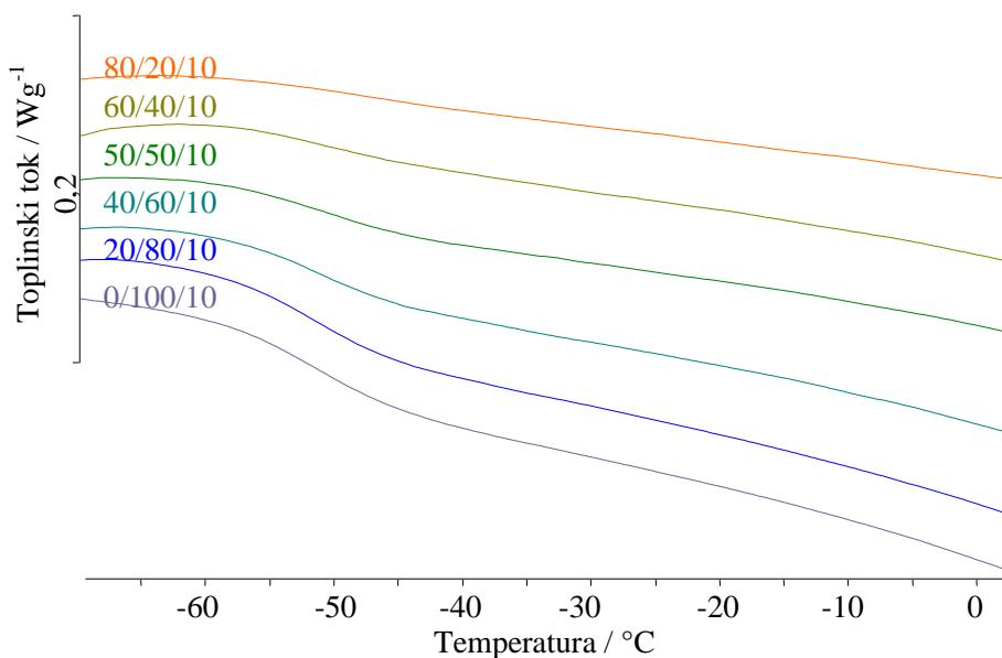
Slika 21. Normalizirane DSC krivulje zagrijavanja mješavina PVC/PEO1/PEG u inertu
