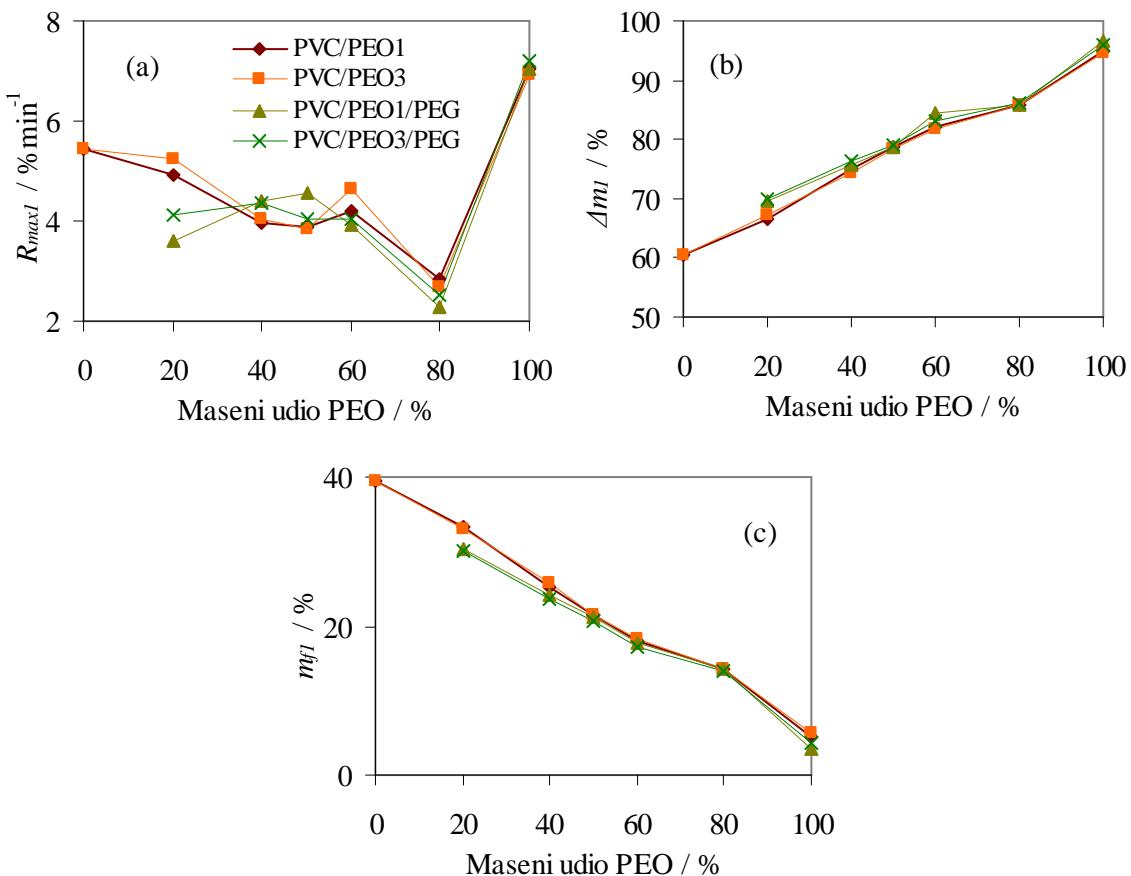
Slika 106. Usporedba značajki procesa dinamičke TG razgradnje istraživanih mješavina pri brzini zagrijavanja  $2,5 \text{ } ^\circ\text{Cmin}^{-1}$  u inertu za prvi razgradni stupanj (a) maksimalna brzina razgradnje ( $R_{max1}$ ), (b) gubitak mase ( $\Delta m_1$ ) i (c) ostatna masa ( $m_{f1}$ )
