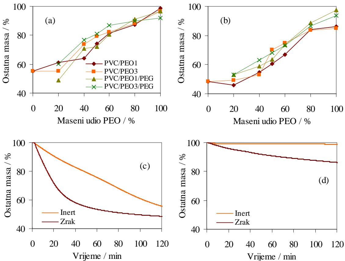
Slika 103. Usporedba ostatnih masa nakon 120 minuta izotermne TG razgradnje istraživanih mješavina svih sastava pri  $240\text{ }^{\circ}\text{C}$  u (a) inertu i (b) zraku; usporedba krivulja izotermne razgradnje u inertu i zraku (c) čistog PVC-a i (d) čistog PEO1-a
