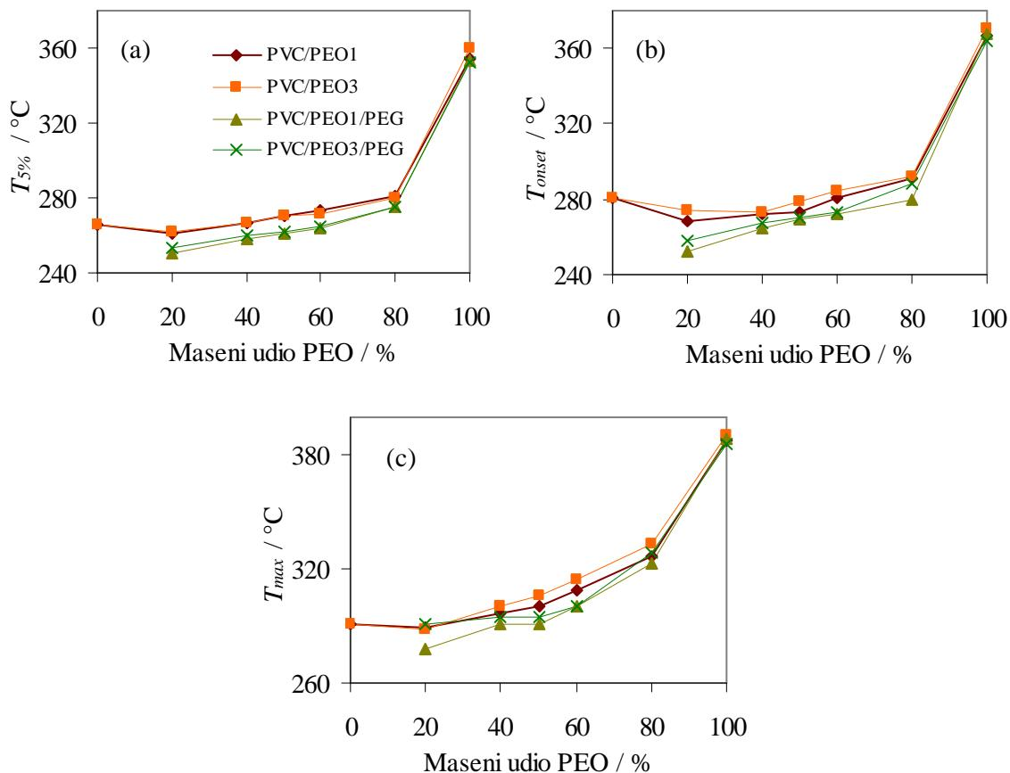
Slika 105. Usporedba karakterističnih temperatura procesa dinamičke TG razgradnje istraživanih mješavina pri brzini zagrijavanja  $2,5 \text{ } ^\circ\text{Cmin}^{-1}$  u inertu za prvi razgradni stupanj (a) temperatura pri kojoj uzorak izgubi 5% početne mase ( $T_{5\%}$ ), (b) temperatura početka razgradnje ( $T_{onset}$ ) i (c) temperatura pri maksimalnoj brzini razgradnje ( $T_{max}$ )
