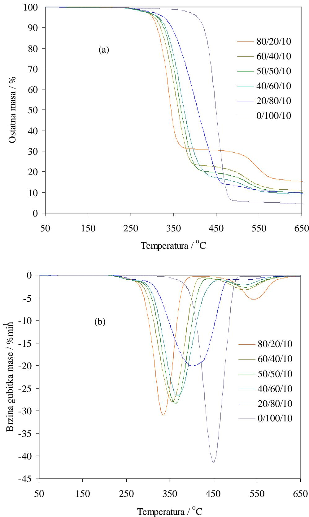
Slika 78. TG (a) i DTG (b) krivulje dinamičke TG razgradnje mješavina PVC/PEO<sub>3</sub>/PEG različitog sastava u zraku pri brzini zagrijavanja  $20\text{ }^{\circ}\text{Cmin}^{-1}$
