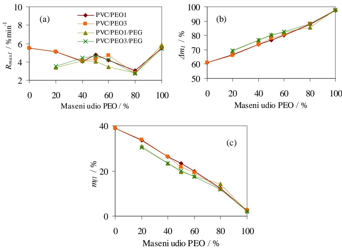
Slika 110. Usporedba ostalih značajki procesa dinamičke TG razgradnje istraživanih mješavina pri brzini zagrijavanja  $2,5 \text{ } ^\circ\text{Cmin}^{-1}$  u zraku za prvi razgradni stupanj (a) maksimalna brzina razgradnje ( $R_{max1}$ ), (b) gubitak mase ( $\Delta m_1$ ) i (c) ostatna masa ( $m_{f1}$ )
