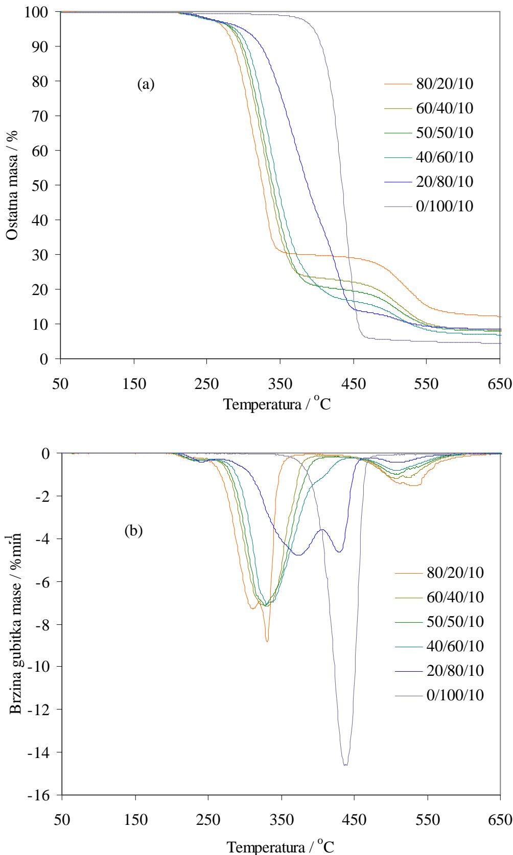
Slika 60. TG (a) i DTG (b) krivulje dinamičke TG razgradnje mješavina PVC/PEO<sub>3</sub>/PEG različitog sastava u inertu pri brzini zagrijavanja  $5\text{ }^{\circ}\text{Cmin}^{-1}$
