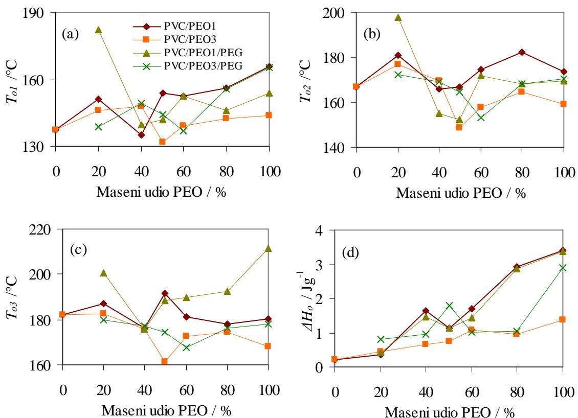
Slika 102. Usporedba značajki DSC krivulja termooksidacijske razgradnje istraživanih mješavina (a) ekstrapolirana početna temperatura ( $T_{o1}$ ), (b) induksijska temperatura oksidacije ( $T_{o2}$ ), (c) temperatura u maksimumu pika oksidacije ( $T_{o3}$ ) i (d) toplina oksidacije ( $\Delta H_o$ )
