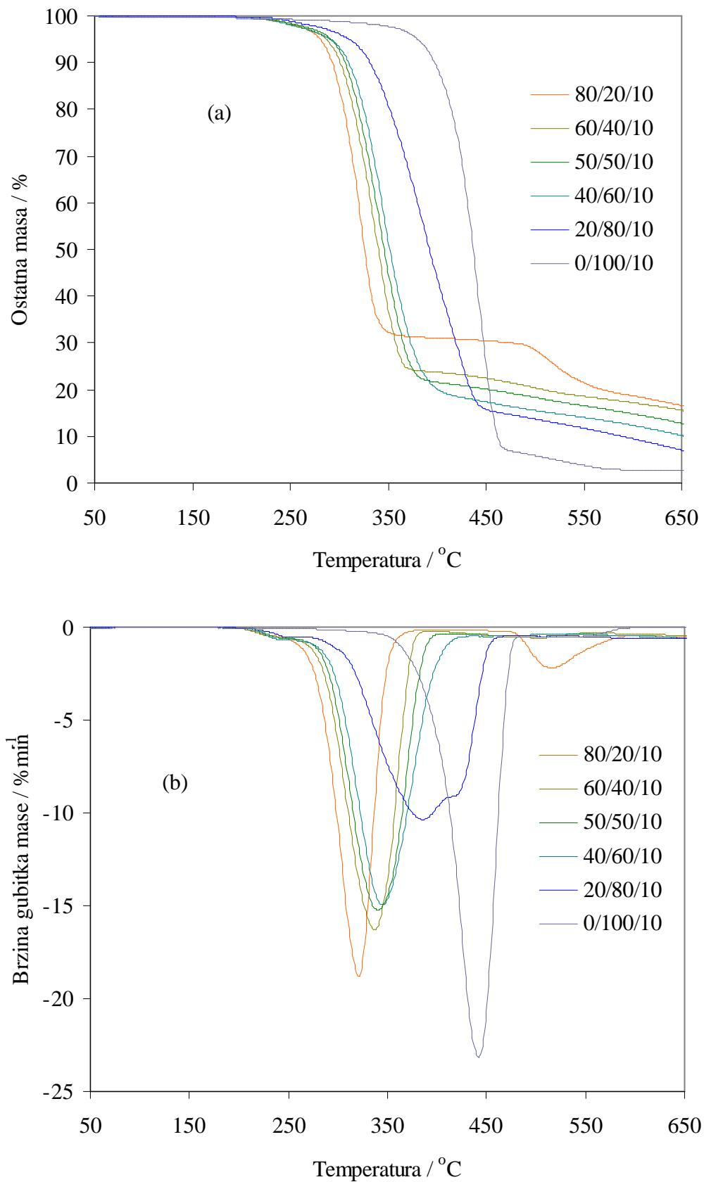
Slika 77. TG (a) i DTG (b) krivulje dinamičke TG razgradnje mješavina PVC/PEO<sub>3</sub>/PEG različitog sastava u zraku pri brzini zagrijavanja  $10\text{ }^{\circ}\text{Cmin}^{-1}$
