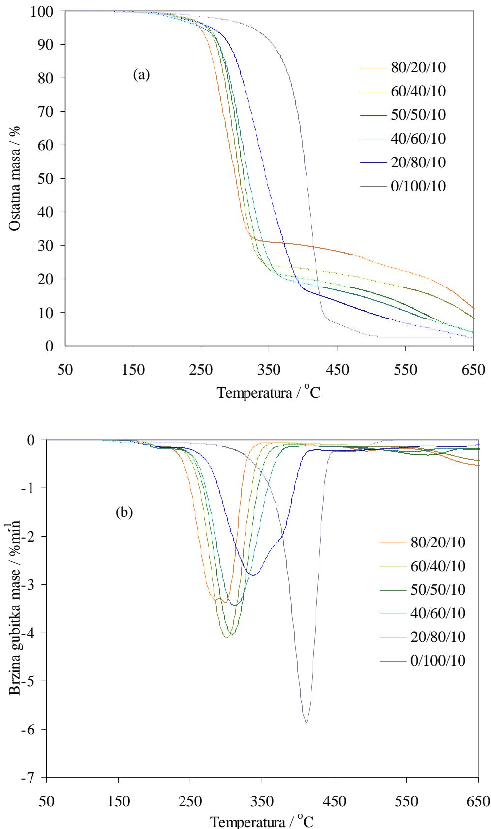
Slika 71. TG (a) i DTG (b) krivulje dinamičke TG razgradnje mješavina PVC/PEO1/PEG različitog sastava u zraku pri brzini zagrijavanja  $2,5 \text{ } ^\circ\text{Cmin}^{-1}$
