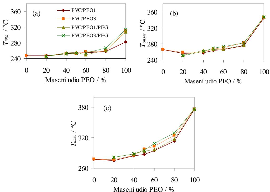
Slika 109. Usporedba karakterističnih temperatura procesa dinamičke TG razgradnje istraživanih mješavina pri brzini zagrijavanja  $2.5 \text{ }^{\circ}\text{C min}^{-1}$  u zraku za prvi razgradni stupanj (a) temperatura pri kojoj uzorak izgubi 5% početne mase ( $T_{5\%}$ ), (b) temperatura početka razgradnje ( $T_{onset}$ ) i (c) temperatura pri maksimalnoj brzini razgradnje ( $T_{max}$ )
