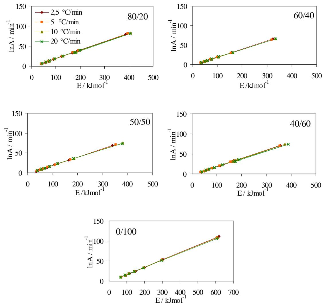
Slika 85. Kompenzacijnska ovisnost kinetičkih parametara  $E$  i  $\ln A$  iz tablica 42-46 za mješavine PVC/PEO1 u inertu
