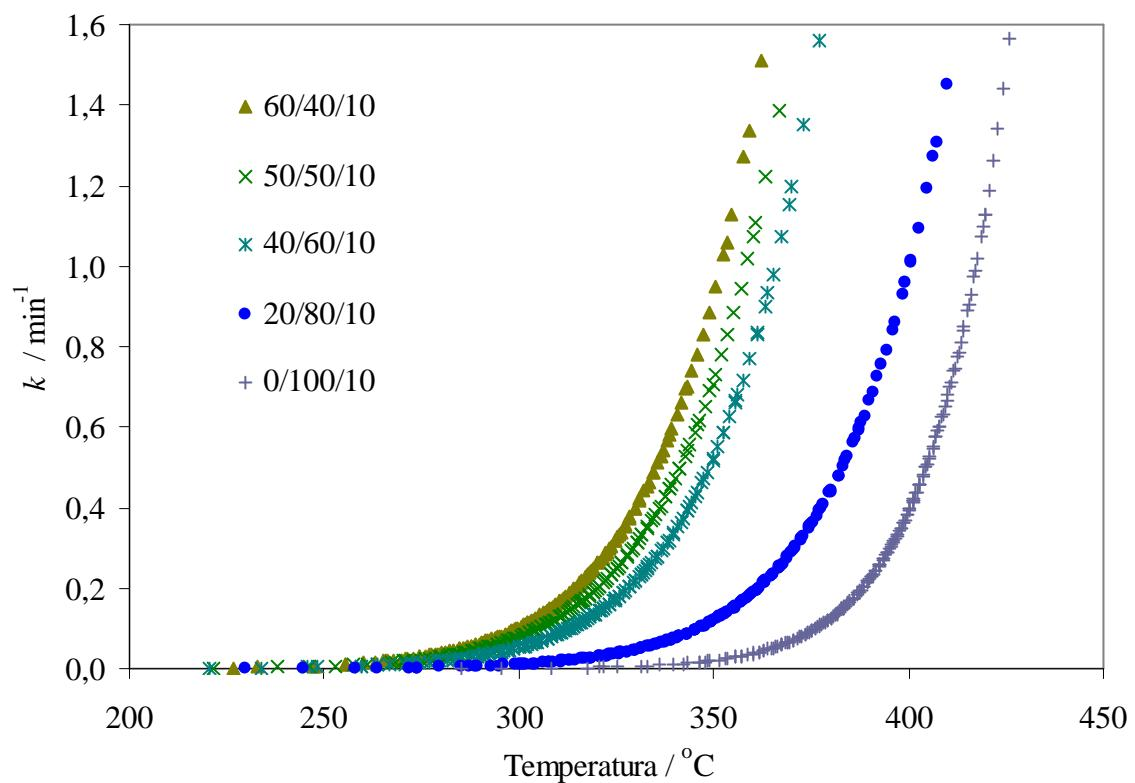
Slika 98. Ovisnost konstante brzine dinamičke TG razgradnje mješavina PVC/PEO<sub>3</sub>/PEG u zraku o temperaturi
