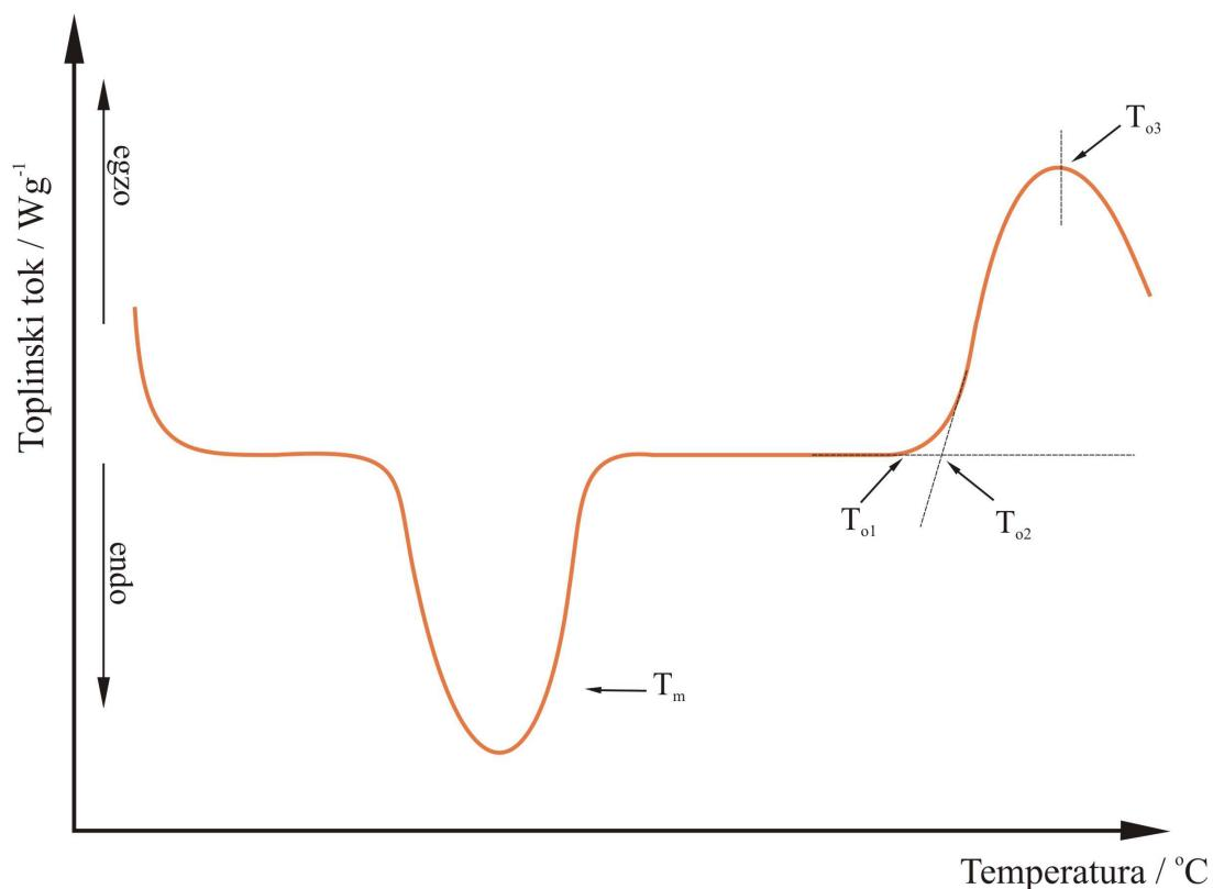
Slika 6. Opći prikaz određivanja induksijske oksidacijske temperature
