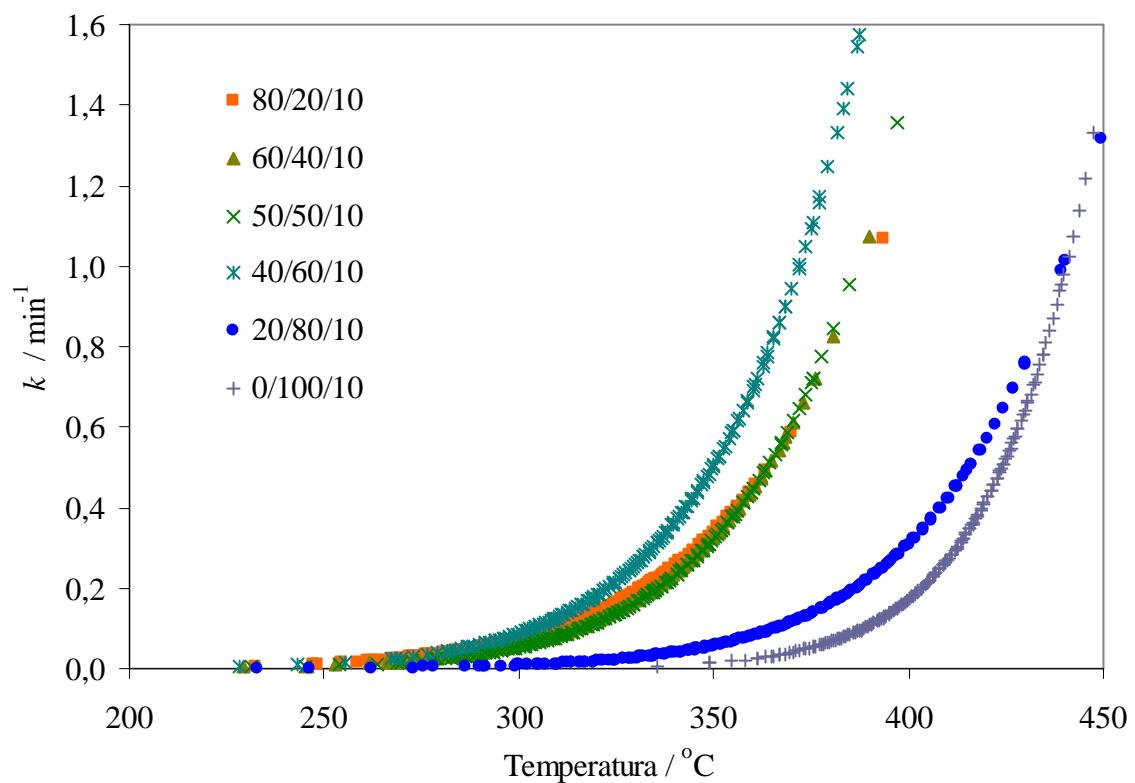
Slika 94. Ovisnost konstante brzine dinamičke TG razgradnje mješavina PVC/PEO<sub>3</sub>/PEG u inertu o temperaturi
