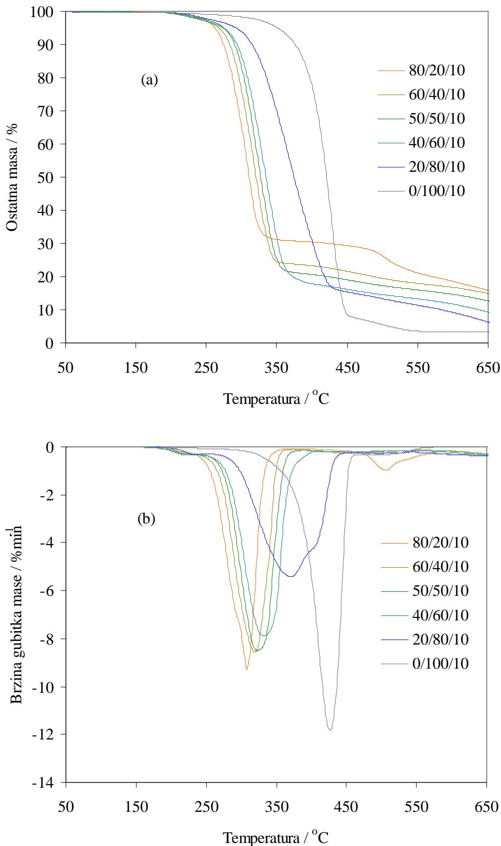
Slika 76. TG (a) i DTG (b) krivulje dinamičke TG razgradnje mješavina PVC/PEO<sub>3</sub>/PEG različitog sastava u zraku pri brzini zagrijavanja  $5\text{ }^{\circ}\text{Cmin}^{-1}$
