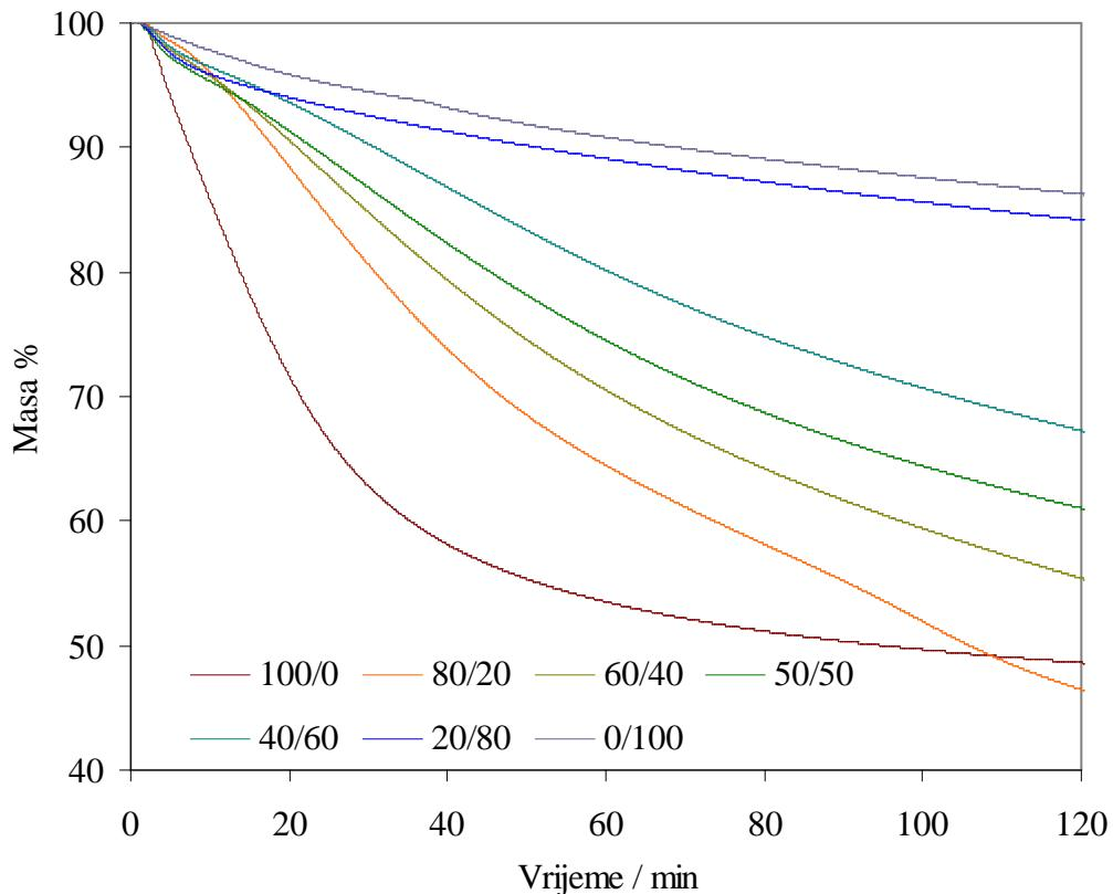
Slika 43. TG krivulje izotermne TG razgradnje mješavina PVC/PEO1 u zraku pri  $240\text{ }^{\circ}\text{C}$
