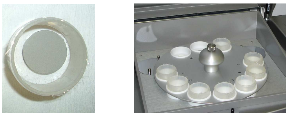
Slika 21. Držač uzorka (a) i rotirajuća ploča (b) unutar EDXRF uređaja
