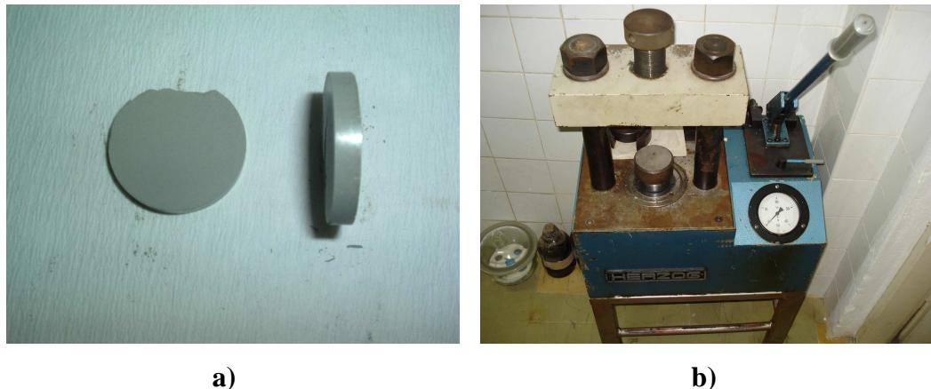
**Slika 20.** Cementna tableta (a)) i hidraulična presa HERZOG (b))
