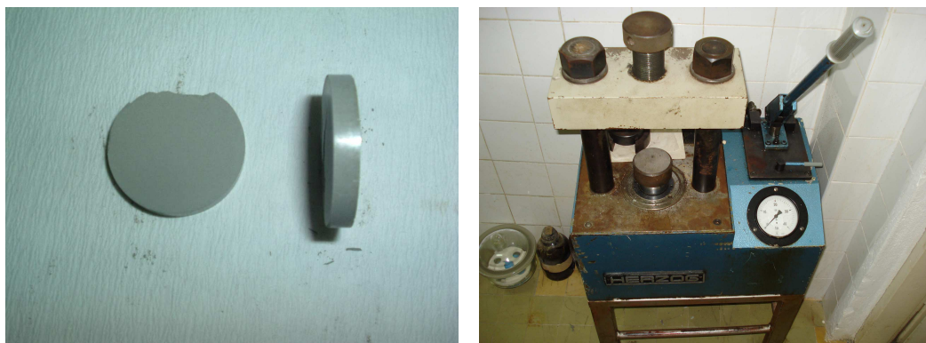
Slika 20. Cementna tableta (a) i hidraulična presa HERZOG (b)
