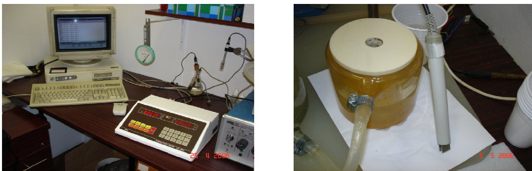
Slika 26. Aparatura za konduktometrijska mjerenja
