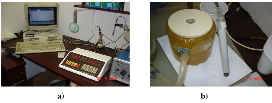
**Slika 26.** Aparatura za konduktometrijska mjerena
