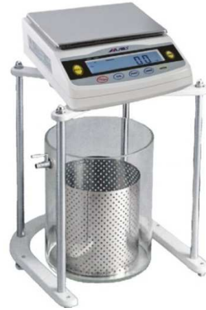
Slika 5. Moderna izvedba hidrostatske vage
