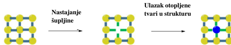
Slika 10. Prikaz ulaska otopljene tvari u strukturu otapala
