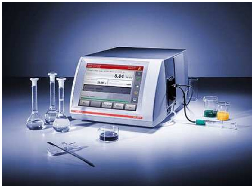
Slika 22. Mjerač gustoće DMA 4500M (Anton Paar)
