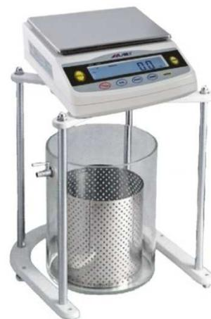
Slika 5. Moderna izvedba hidrostatske vase
