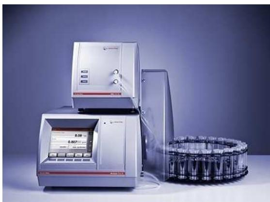
Slika 8. Digitalni denzitometar
