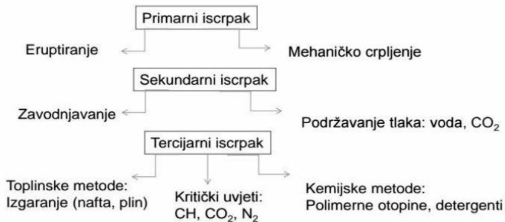
Slika 1.2. Shema ukupnog procesa crpljenja nafte iz ležišta. 1
