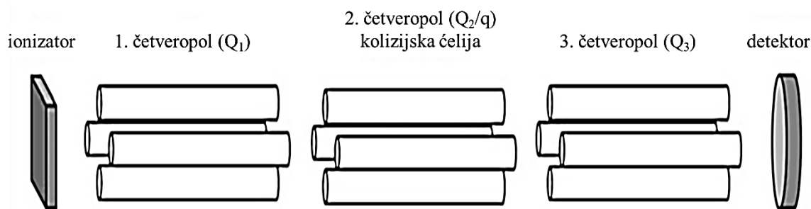
Slika 16. Shematski prikaz trostrukog četveropolnog analizatora masa. 30
