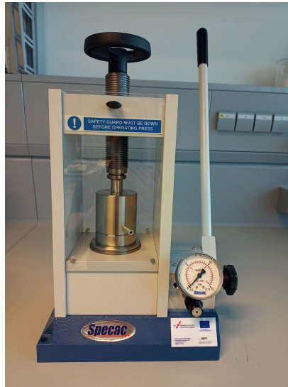
Slika 14. Hidraulična presa SPECAC, model 15 T.
