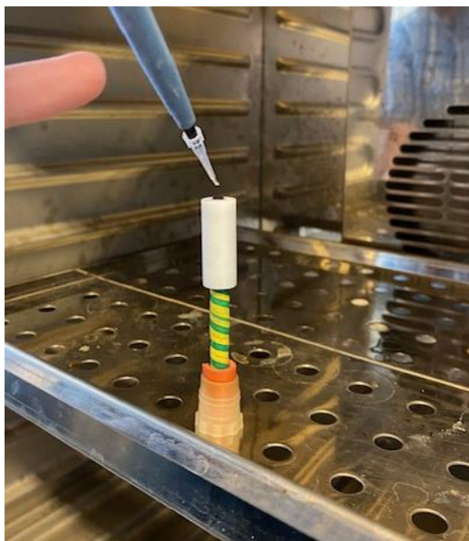
Slika 20 Proces nanošenja kompleksa na GCE
