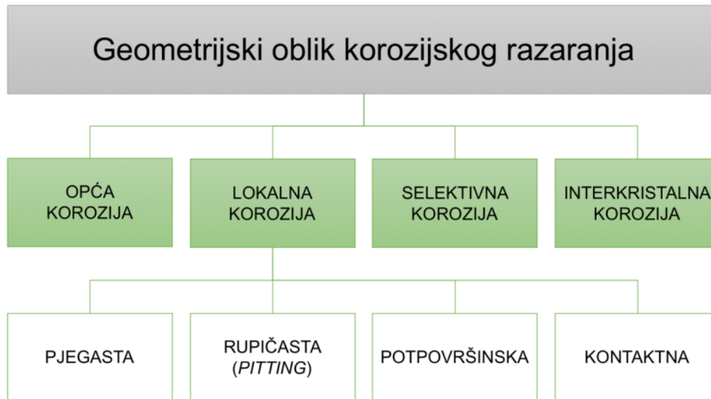
Slika 4. Klasifikacija korozije prema geometrijskom obliku korozijskog razaranja. 5
