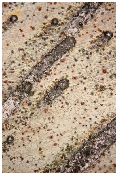
Slika 39. Površina S275 uzorka nakon PD mjerenja u gorkoj morskoj vodi pri T = 15^{\circ}\text{C} bez inhibitora (a) i uz inhibitor (b).
