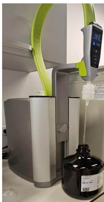
Slika 13. Uređaj za pročišćavanje vode
