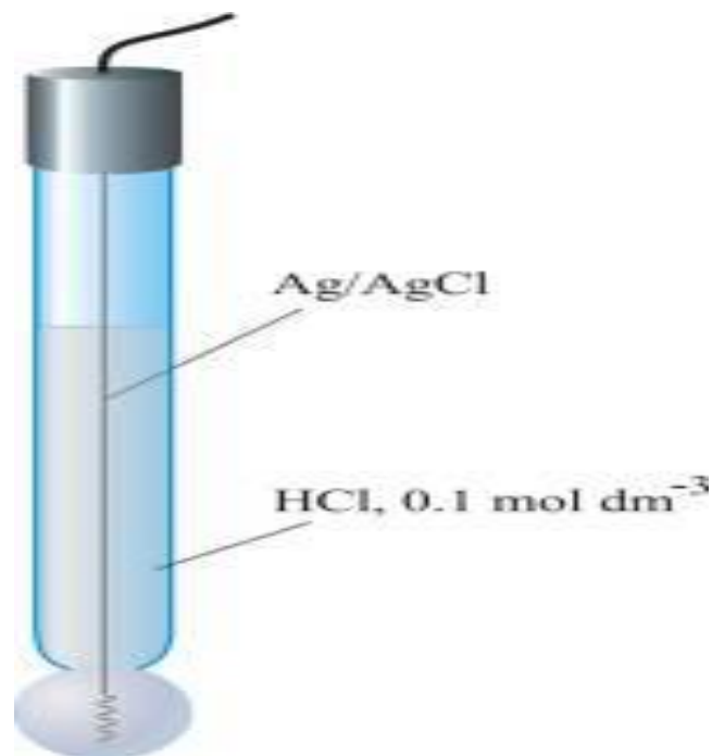
Slika 2. Elektroda sa staklenom membranom
