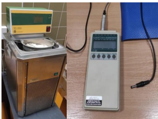
Slika 16. Termostat sa mikrokalorimetrijskom ćelijom i Data Logger za praćenje hidratacije portland cementa
