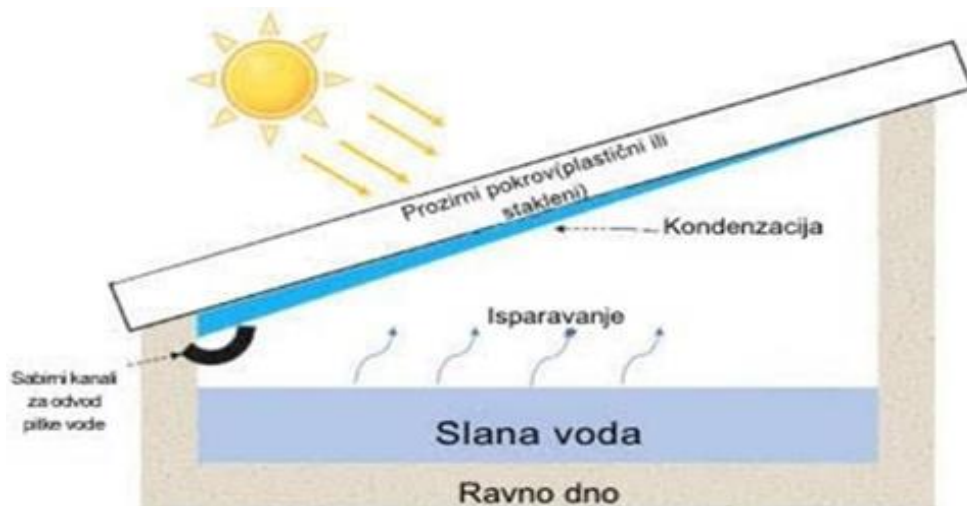
Slika 19. Shema uređaja za izravnu sunčevu destilaciju s ravnim dnom 25
