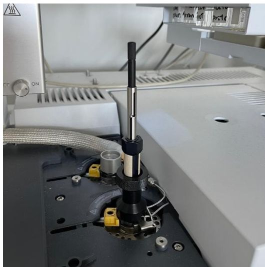
Slika 20. SPME nosač s vlaknom umetnut u GC-MS injektor (desorpcija ekstrahiranih spojeva)
