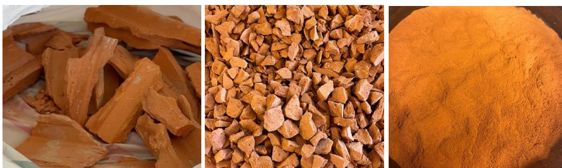
Slika 8. Otpadna građevinska opeka (a), izlomljena (b), samljevena i prosijana (c) građevinska opeka
