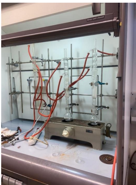
Slika 6. Aparatura za Soxlet (vlastita fotografija)
