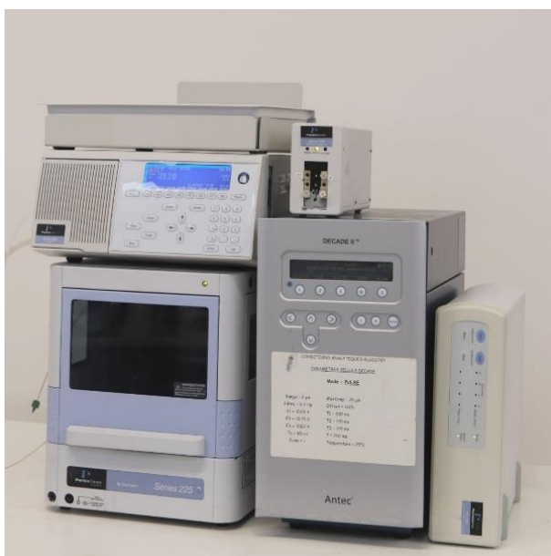
Slika 5. Primjer izgleda tekućinskog kromatografa Perkin Elmer 19
