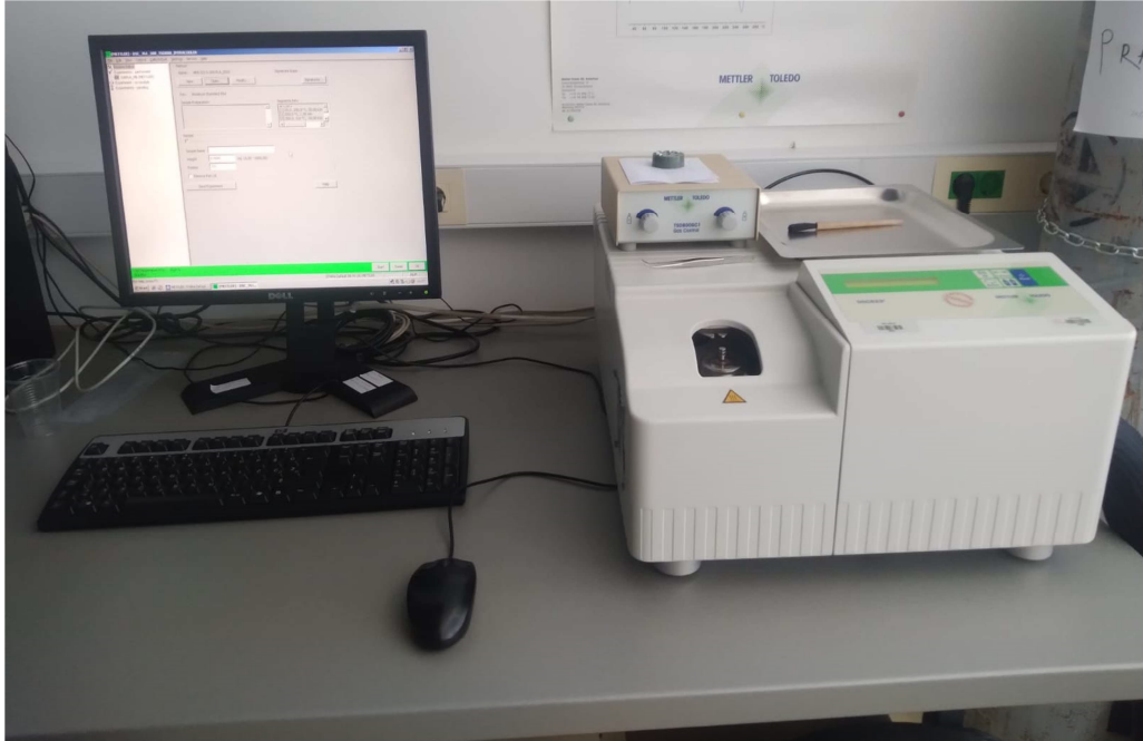
Slika 23. Prikaz diferencijalnog pretražnog kalorimetra DSC 823 e
