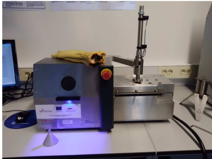
Slika 20. Prikaz ekstrudera HAAKE MiniLab 3 (Thermo Scientific, SAD)
