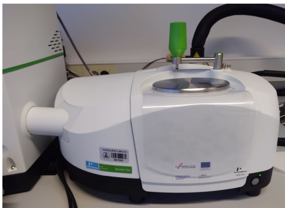
Slika 22. Prikaz spektrometra Spectrum Two (Perkin Elmer SAD)
