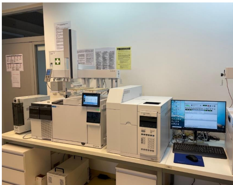
Slika 10. Vezani sustav plinska kromatografija-spektrometrija masa
