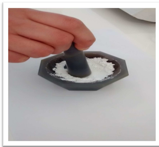
Slika 7. Priprema TiO 2 paste u tarioniku
