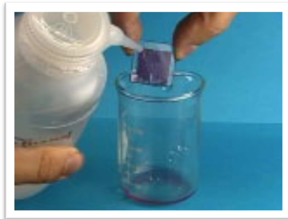
Slika 13. Ispiranje stakalca etanolom
