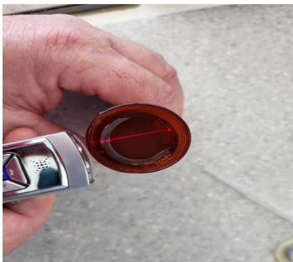
Slika 17. Dokaz postojanja koloidnih čestica srebra prolazom laserske zrake kroz koloidnu suspenziju
