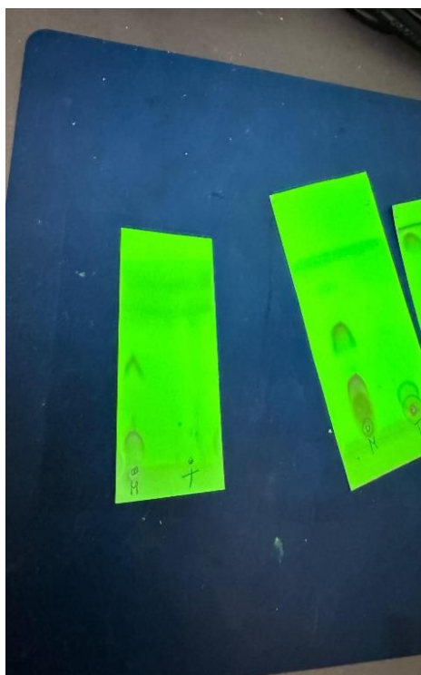
Slika 29. TLC pločice nakon detekcije
