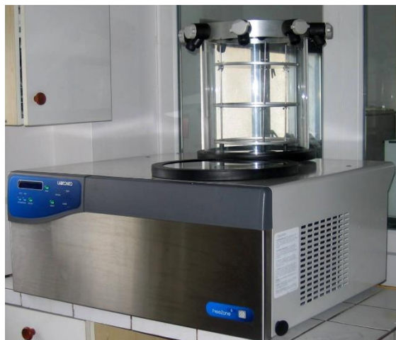
Slika 20. Uređaj za sušenje liofilizacijom
