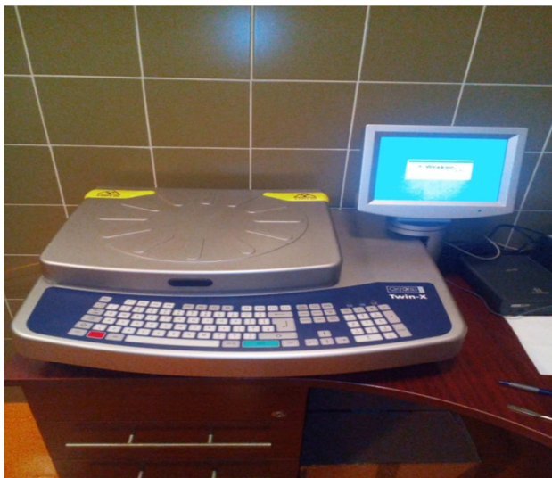
Slika 6. EDXRF uređaj za kvantitativnu analizu.
