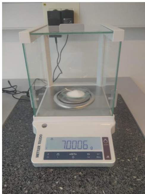
Slika 18. Analitička vaga korištena za vaganje uzoraka ( Gold Balance JE503GE )
