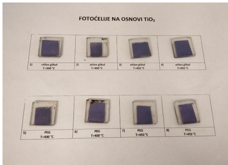
Slika 27. Stakalca s nanesenim oksidnim slojem i apsorbiranim bojilom
