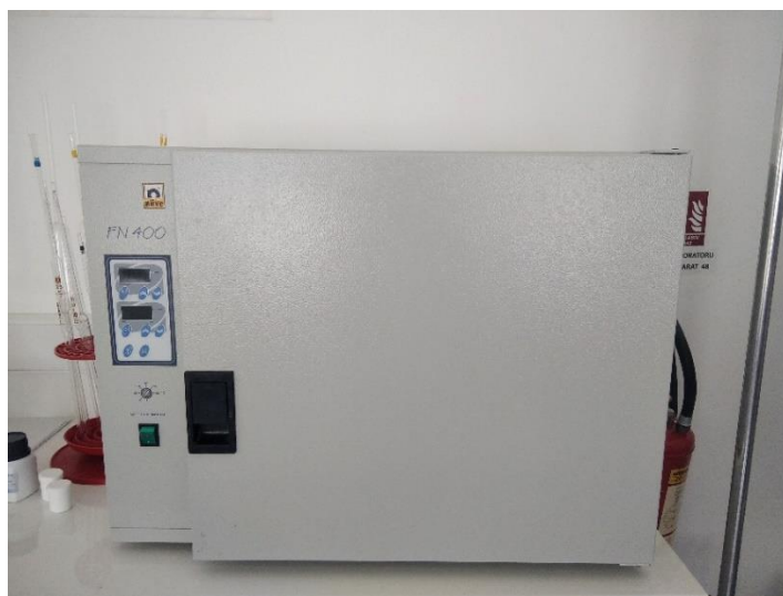
Slika 23. Laboratorijski sušionik (FN 400)
