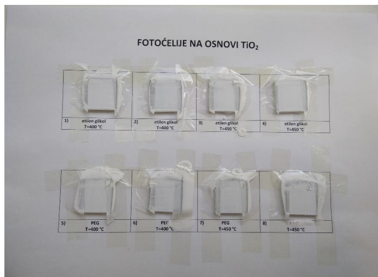
Slika 22. Stakalca s nanesenom \text{TiO}_2 pastom
