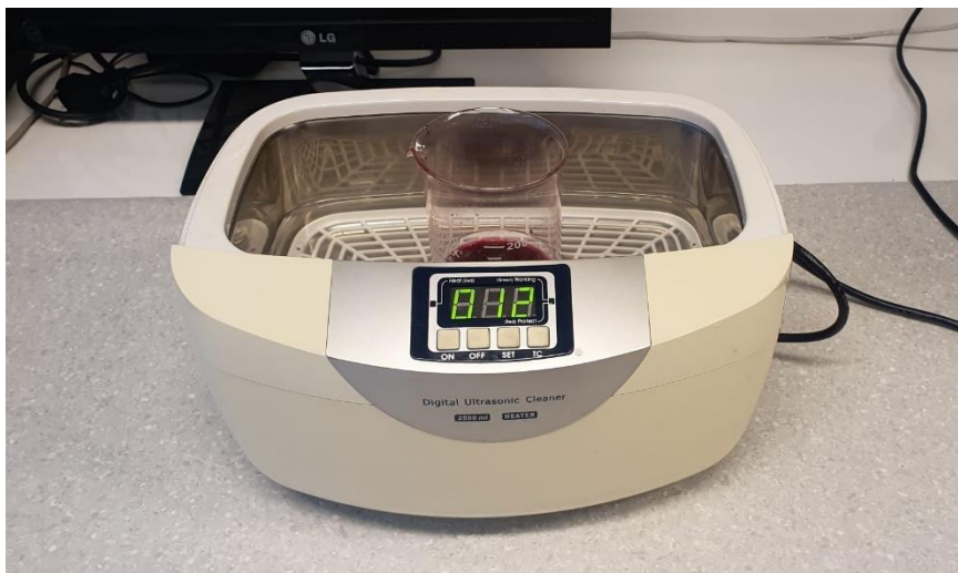
Slika 16. Ultrazvučno potpomognuta ekstrakcija antocijanina u kupelji ( Digital Ultrasonic Cleaner )
