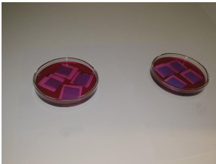
Slika 25. Stakalca sa slojem \text{TiO}_2 uronjena u otopinu antocijanina
