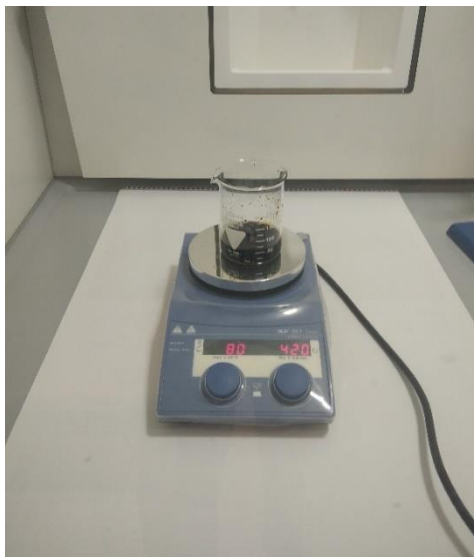
Slika 19. Magnetska miješalica korištena za pripravu gel elektrolita ( RCT basic )
