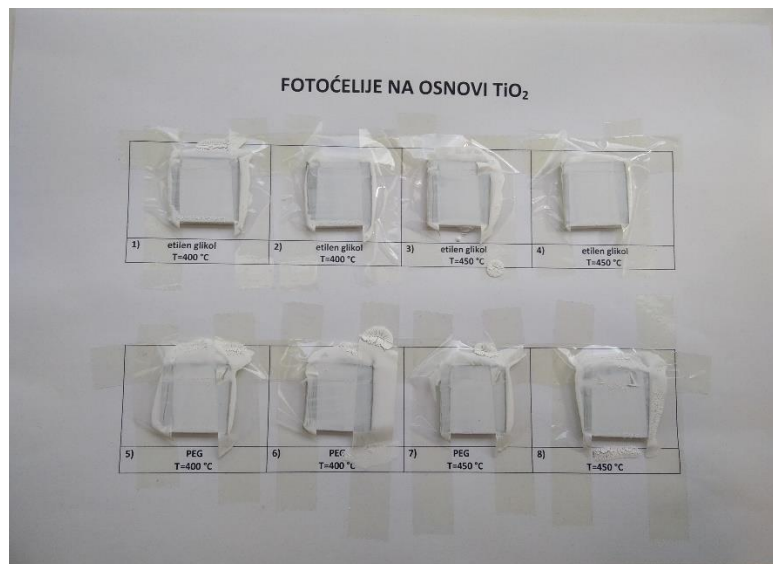
Slika 22. Stakalca s nanesenom \text{TiO}_2 pastom
