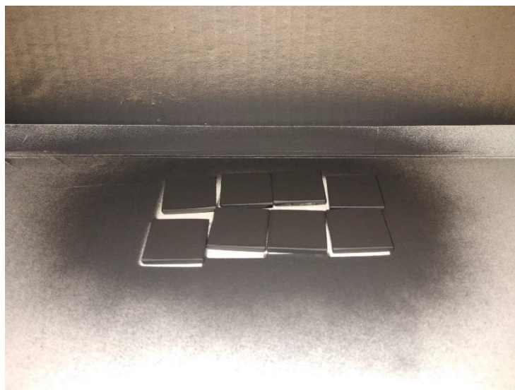
Slika 28. Stakalca s tek nanesenim grafitnim slojem
