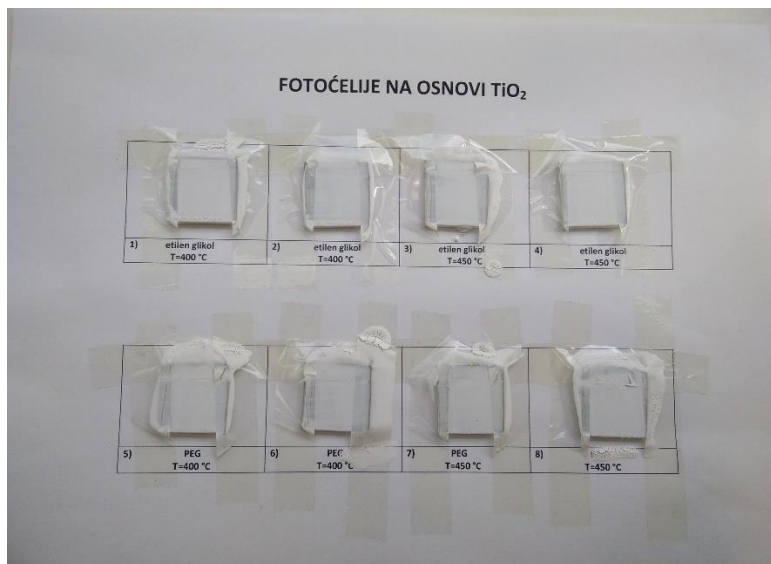
Slika 22. Stakalca s nanesenom \text{TiO}_2 pastom
