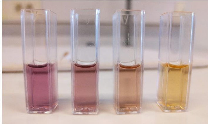
Slika 21. Promjena boje uzoraka otopine DPPH u ovisnosti o antioksidacijskoj aktivnosti (autorska slika)
