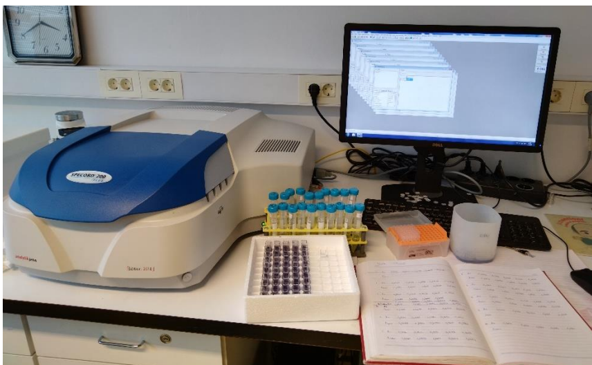
Slika 22. Uzorci ispitivanih cvjetova za određivanje antioksidacijske aktivnosti i spektrofotometar (SPECORD 200 PLUS) (autorska slika)
