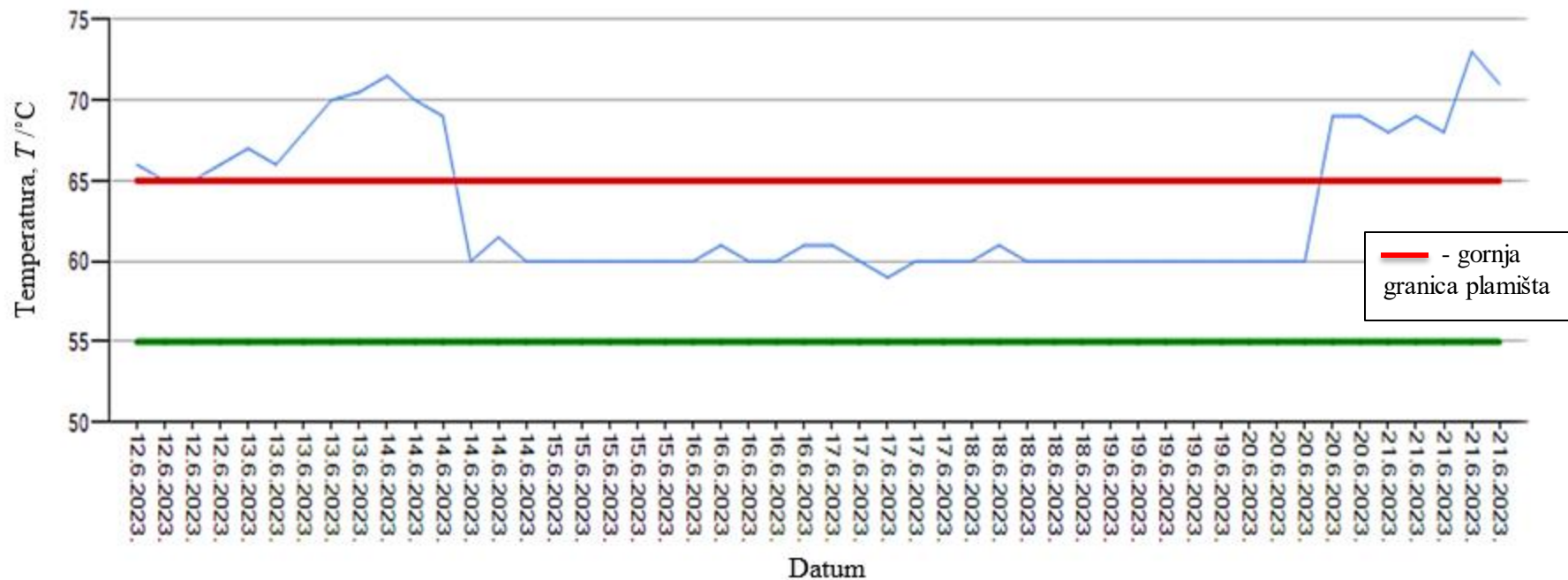
Slika 16. Prikaz plamništa dizela tijekom vremena
