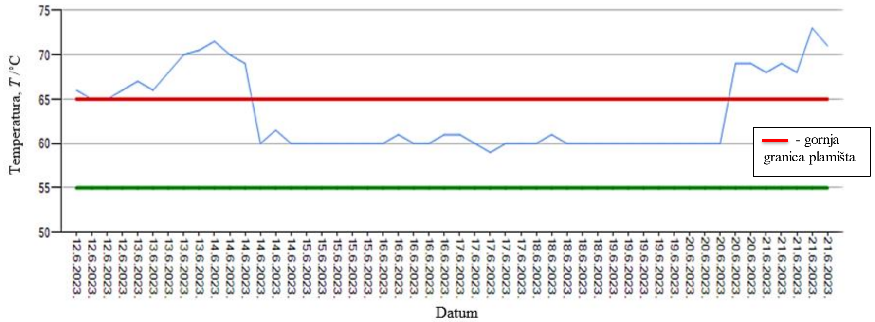
Slika 16. Prikaz plamišta dizela tijekom vremena
