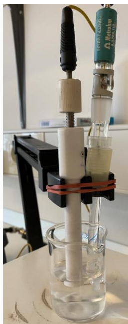
Slika 22. Ćelija s elektrodom na bazi paste od ugljikovog materijala i referentom elektrodom
