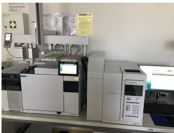
Slika 21. Vezani sustav plinska kromatografija- spektrometrija masa (GC-MS) (izvor: autor)
