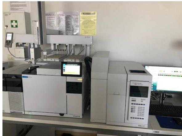
**Slika 21.** Vezani sustav plinska kromatografija- spektrometrija masa (GC-MS) (izvor:
