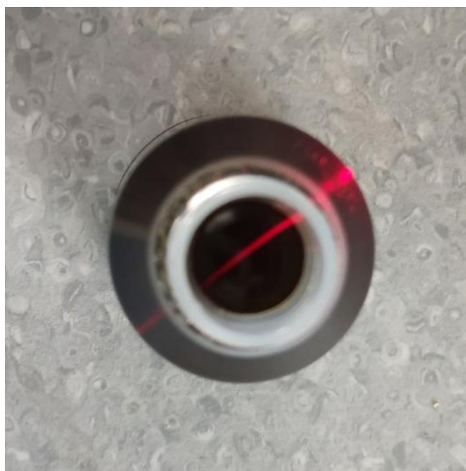
Slika 23 .Tyndallov efekt pri pH=9
