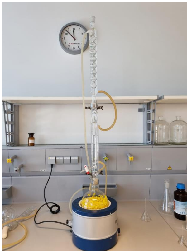
Slika 18. Aparatura za vodenu destilaciju po Clevengeru (modificirana)
