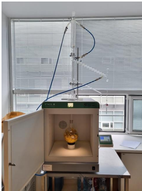
Slika 22. Mikrovalna ekstrakcija cvjetova brnistre bez otapala
