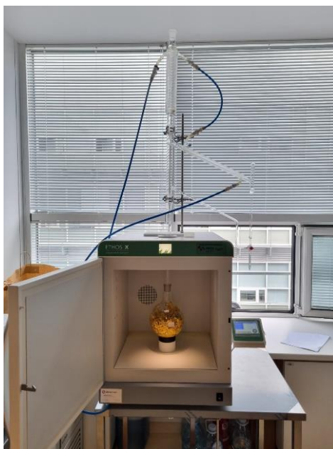
Slika 22. Mikrovalna ekstrakcija cvjetova brnistre bez otapala
