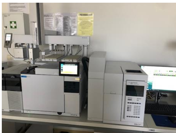
Slika 26. Vezani sustav plinska kromatografija- spektrometrija masa (GC-MS) (izvor: autor)
