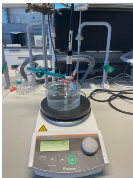
Slika 25. Aparatura za HS-SPME (Izvor: autor)
