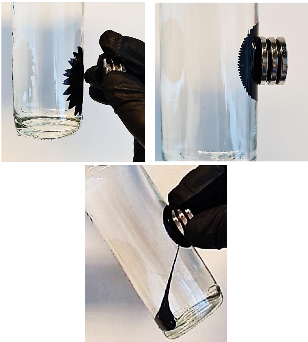
Slika 33. Prikaz karakterističnih šiljaka kada je magnet prislonjen uz bočni dio bočice u kojoj se nalazi ferofluid pripravljen s amonijevim oleatom kao surfaktantom
