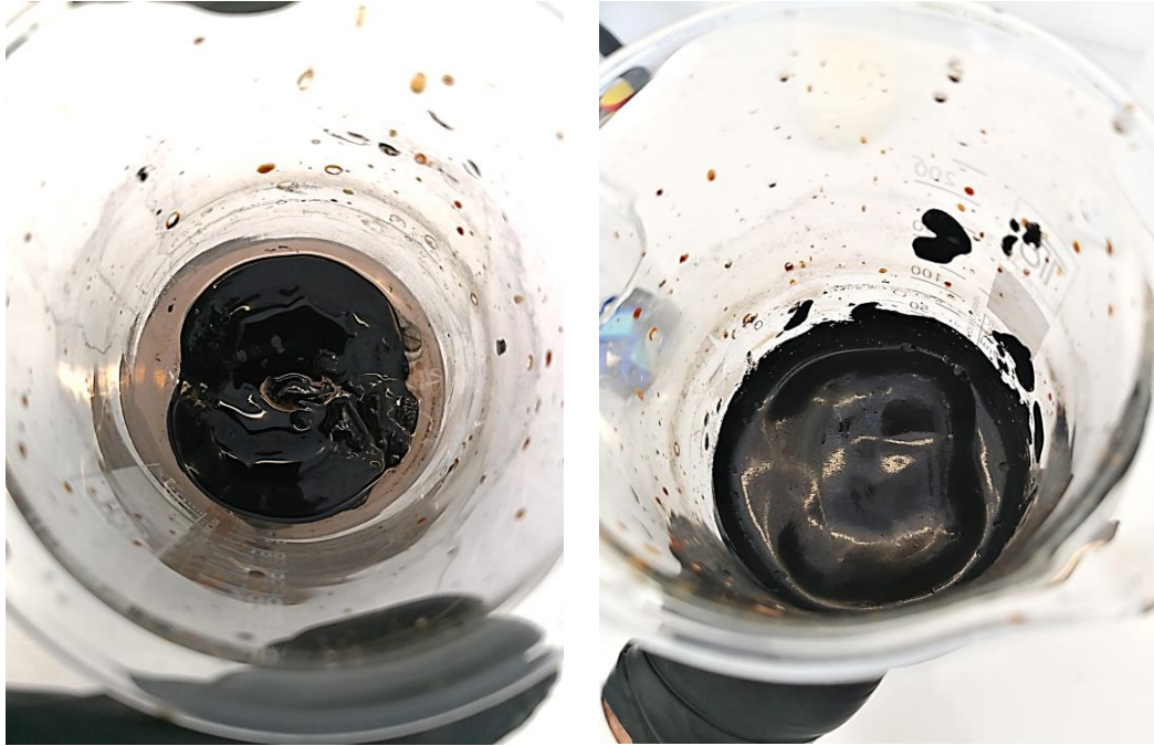
Slika 26. Ferofluid pripravljen uz primjenu oleinske kiseline kao surfaktanta prije (lijevo) i nakon (desno) dodavanja surfaktanta
