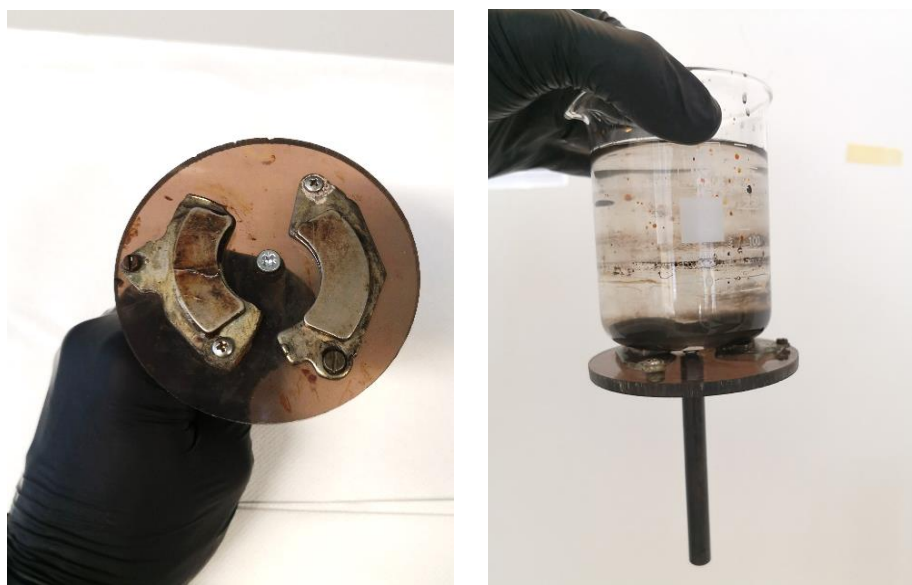
Slika 21. Improvizirani permanentni magnet na stalku (lijevo) i prikaz taloženja čestica nanomagnetit na dnu čaše uslijed djelovanja magnetskog polja (desno)
