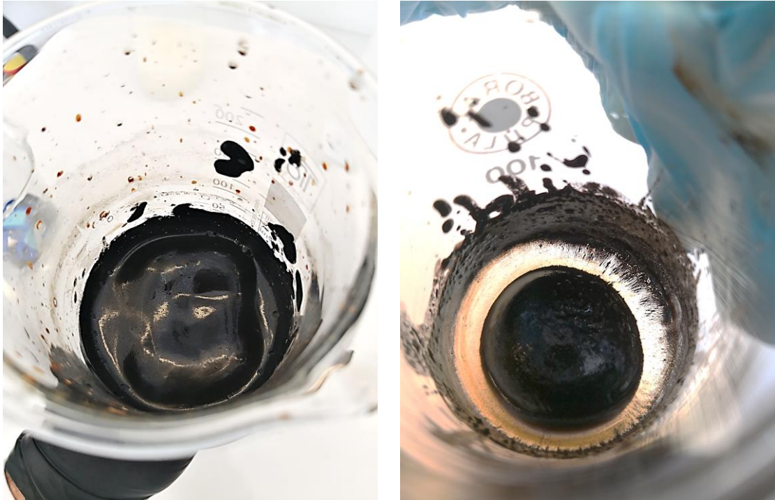
Slika 35. Ferrofluid pripravljen uz primjenu oleinske kiseline kao surfaktanta dodavanjem surfaktanta neosušenom nanomagnetitu (lijevo) i ferrofluid pripravljen miješanjem oleiske kiseline s čvrstim nanomagnetitom (desno)
