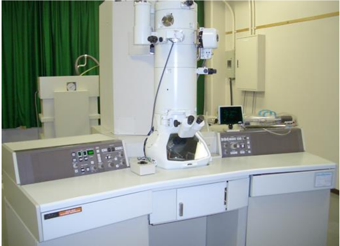
Slika 37. Transmisijski elektronski mikroskop (TEM) model JEM-2010HR
