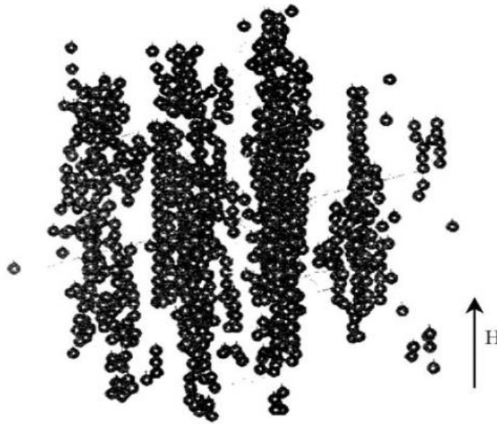
Slika 8. Prikaz lančanih struktura sačinjenih od magnetskih nanočestica orijentiranih u smjeru primjenjenog magnetskog polja
