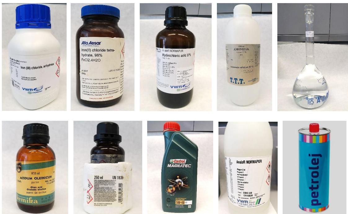
Slika 18. Kemikalije korištene za sintezu nanomagnetita i pripravu ferofluksa
