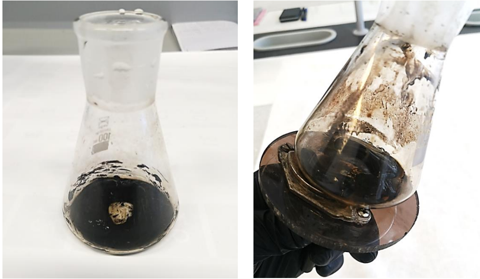
Slika 25. Ferofluid pripravljen uz primjenu tetrametilamonijeva hidroksida (TMAH) kao surfaktanta bez primjene vanjskog magnetskog polja (lijevo) i uz primijenjeno vanjsko magnetsko polje (desno)
