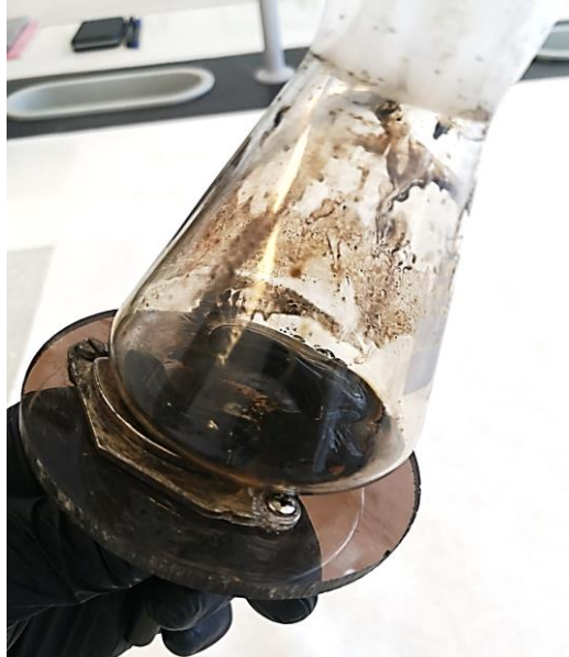
Slika 34. Ferrofluida pripremljen uz primjenu tetrametilamonijeva hidroksida (TMAH) kao surfaktanta
