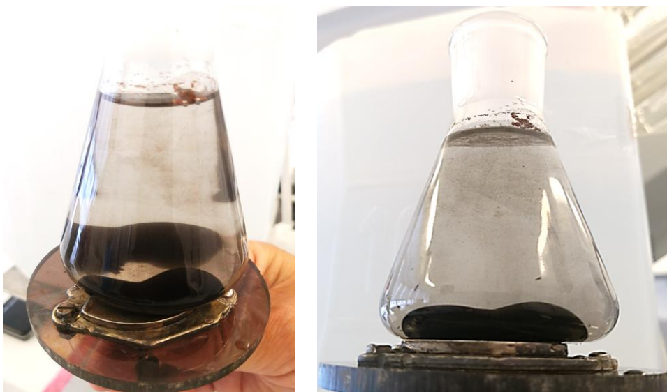
Slika 24. Prikaz taloženja čestica nanomagnetita na dnu Erlenmeyerove tikvice, tokom procesa odlijevanja, pod djelovanjem vanjskog magnetskog polja
