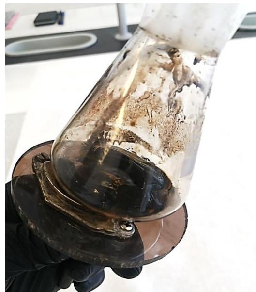
Slika 34. Ferofluida pripravljen uz primjenu tetrametilamonijeva hidroksida (TMAH) kao surfaktanta
