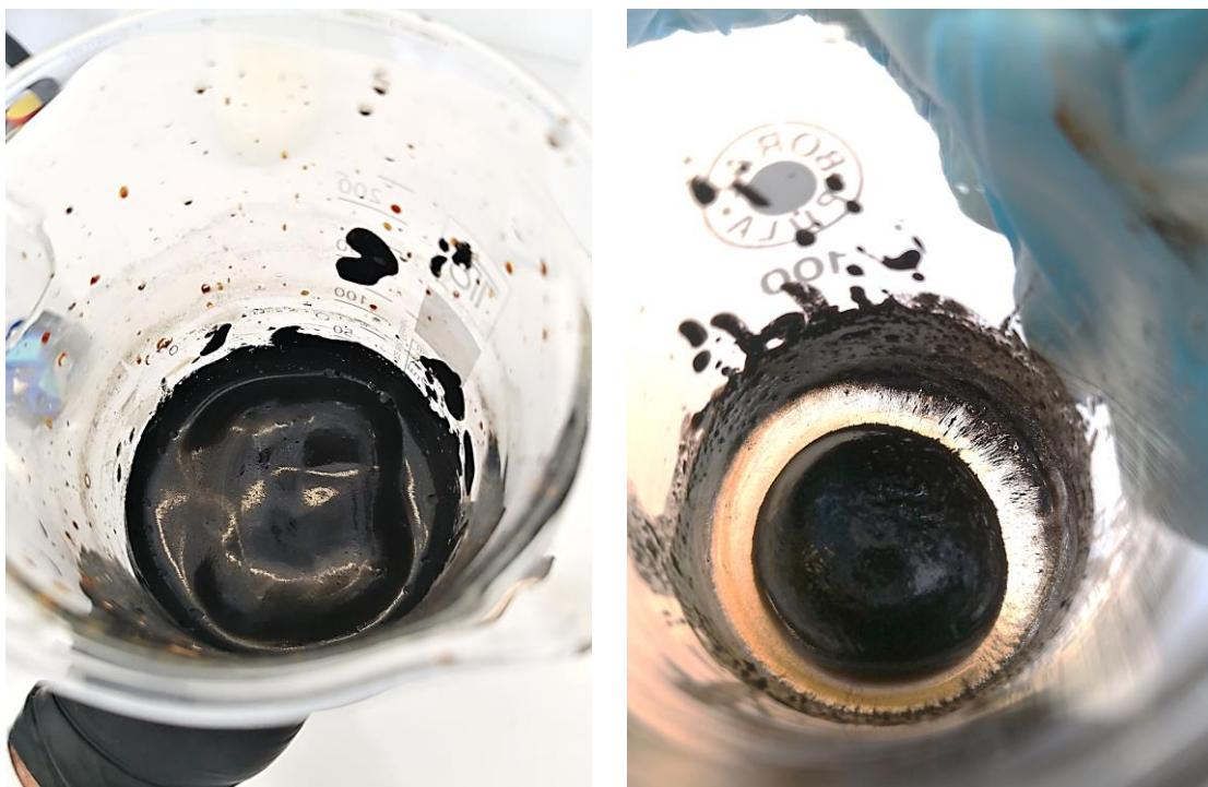
Slika 35. Ferofluid pripravljen uz primjenu oleinske kiseline kao surfaktanta dodavanjem surfaktanta neosušenom nanomagnetitu (lijevo) i ferofluid pripravljen miješanjem oleiske kiseline s čvrstim nanomagnetitom (desno)
