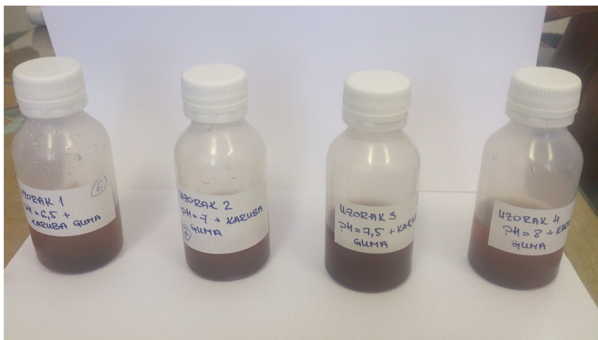
Slika 26. Dobiveno koloidno srebro "zelenom" sintezom pomoću meda uz različite pH vrijednosti od 6,5 do 8,0 te dodatak karuba gume, w = 5%.
