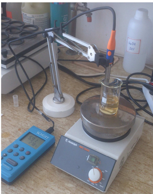
Slika 3. Aparatura za dobivanje koloidnog srebra
