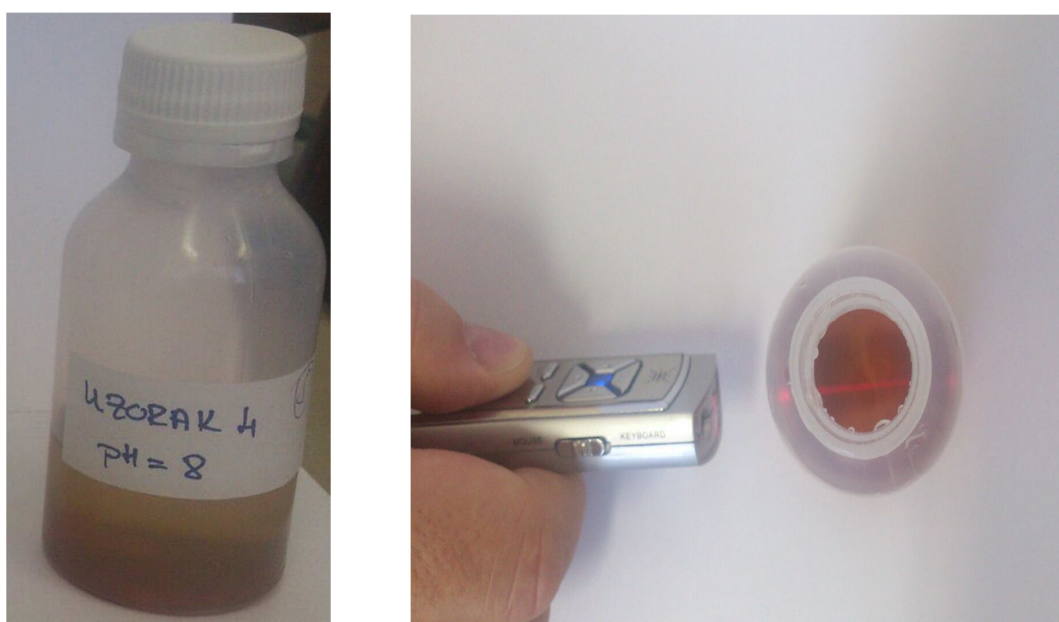
Slika 37. Tyndallov efekt kod uzorka broj 4 dobivenog "zelenom" sintezom.
