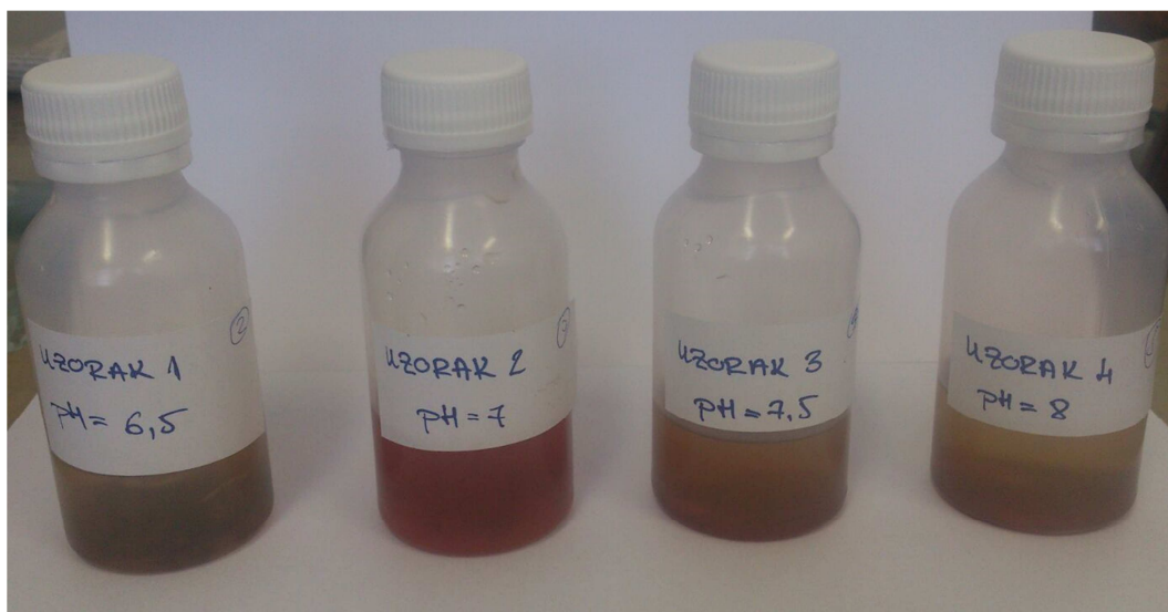
Slika 25. Dobiveno koloidno srebro "zelenom" sintezom pomoću meda uz različite pH vrijednosti od 6,5 do 8,0.
