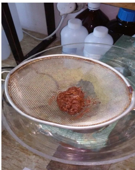
Slika 19. Dobivena karuba guma nakon filtracije kroz metalno sito
