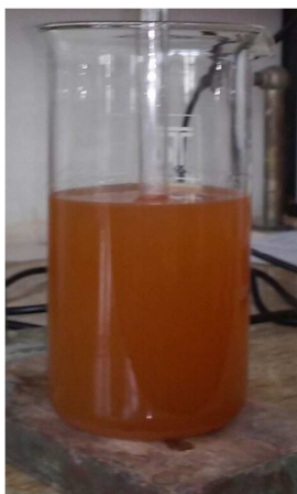
Slika 18. Obrada filtrata izopropanolom s omjerom 2 : 1 u odnosu na dobiveni filtrat (duplo više izopropanola), uz miješanje 2 sata pri sobnoj temperaturi.
