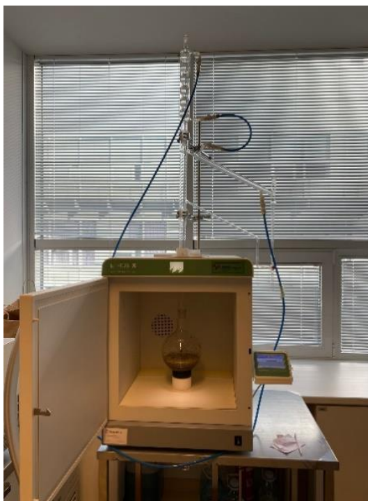
Slika 9. Mikrovalovima potpomognuta destilacija
