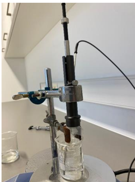
Slika 10. Mikroekstrakcija na čvrstoj fazi
