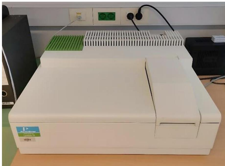
**Slika 13.** UV/Vis spektrofotometar *PerkinElmer Lambda 25*
