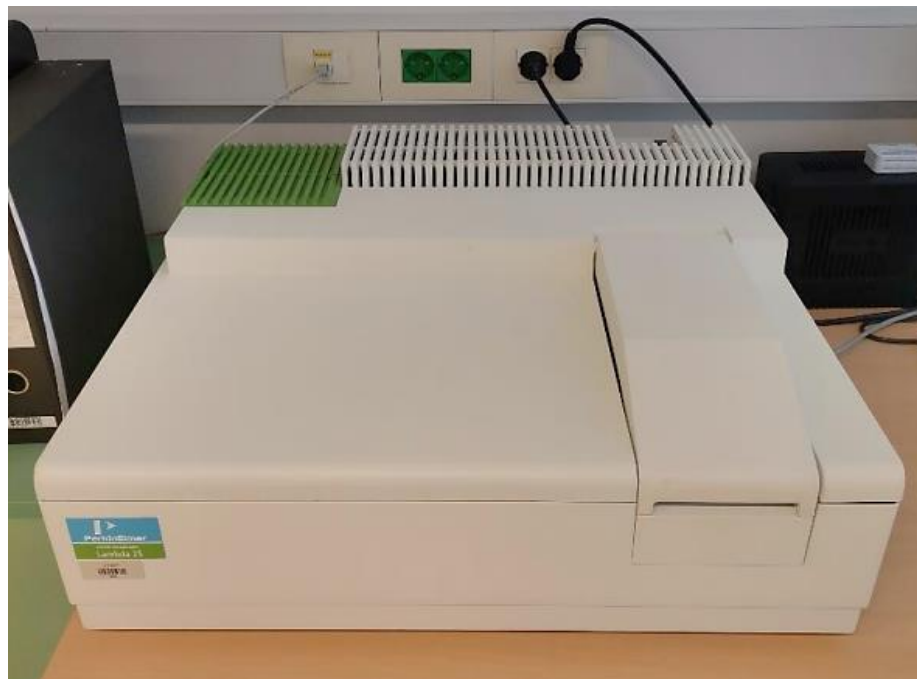
Slika 13. UV/Vis spektrofotometar PerkinElmer Lambda 25
