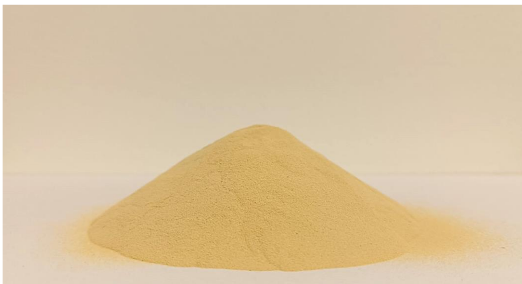
Slika 10. Zeolit NaX veličinske klase čestica manje od 90 \mu\text{m}
