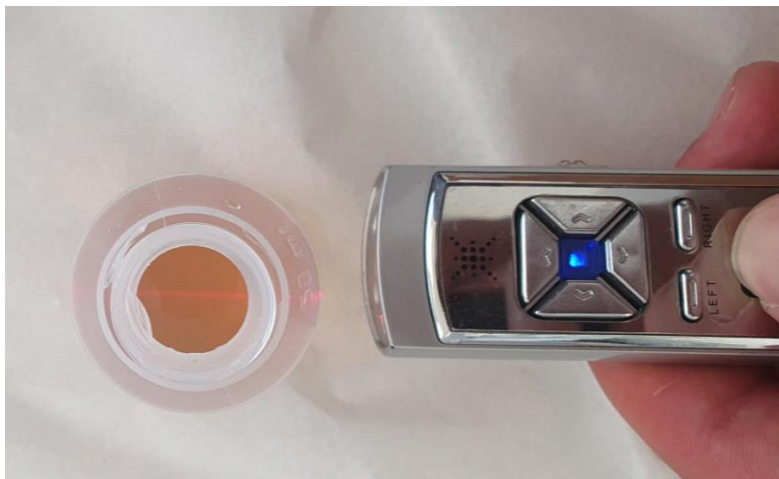
Slika 14. Tyndallov efekt za otopinu pH = 7
