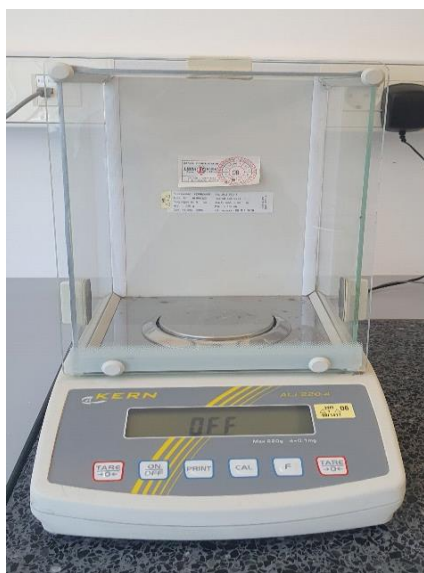
Slika 6. Analitička vaga, Kern, ALJ 220 - 4
