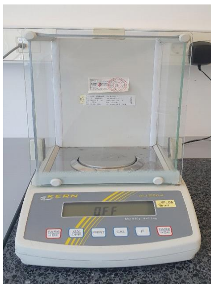
Slika 6. Analitička vaga, Kern, ALJ 220 - 4
