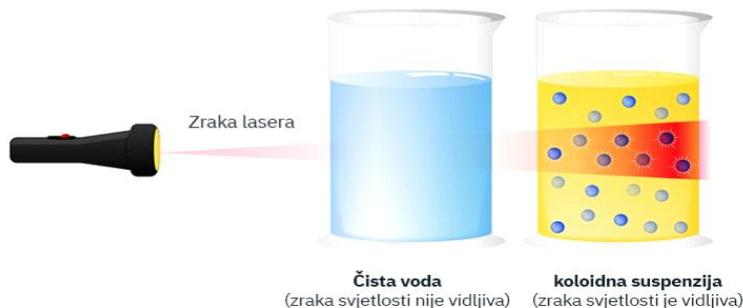
Slika 3. Tyndallov efekt za pravu otopinu i koloidni sustav<sup>11</sup>
