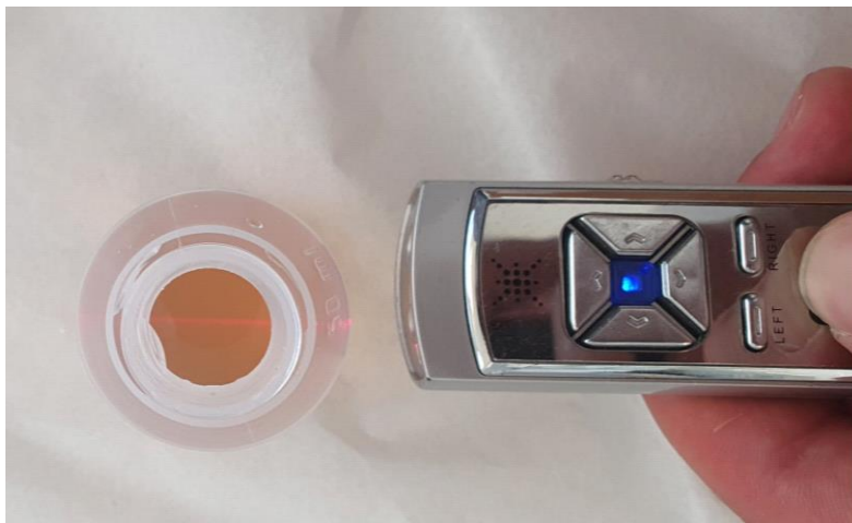
Slika 14. Tyndallov efekt za otopinu pH = 7
