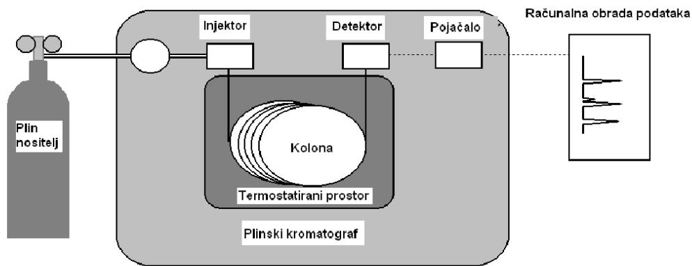
**Slika 8.** Shematski prikaz plinskog kromatografa<sup>42</sup>
